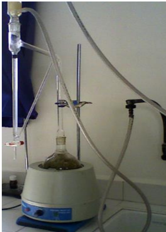
Dispositif d'extraction des HEs par hydrodistillation de type Clevenger
