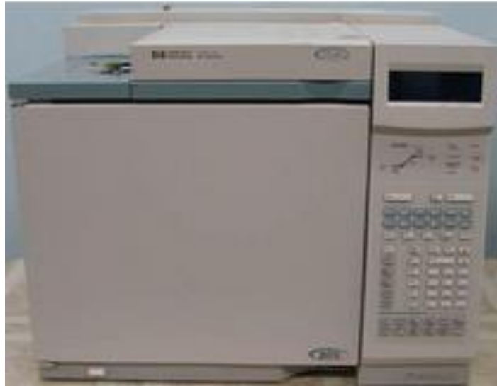
Chromatographe en phase gazeuse à régulation électronique de type Hewlett Packard (série HP 6890)
