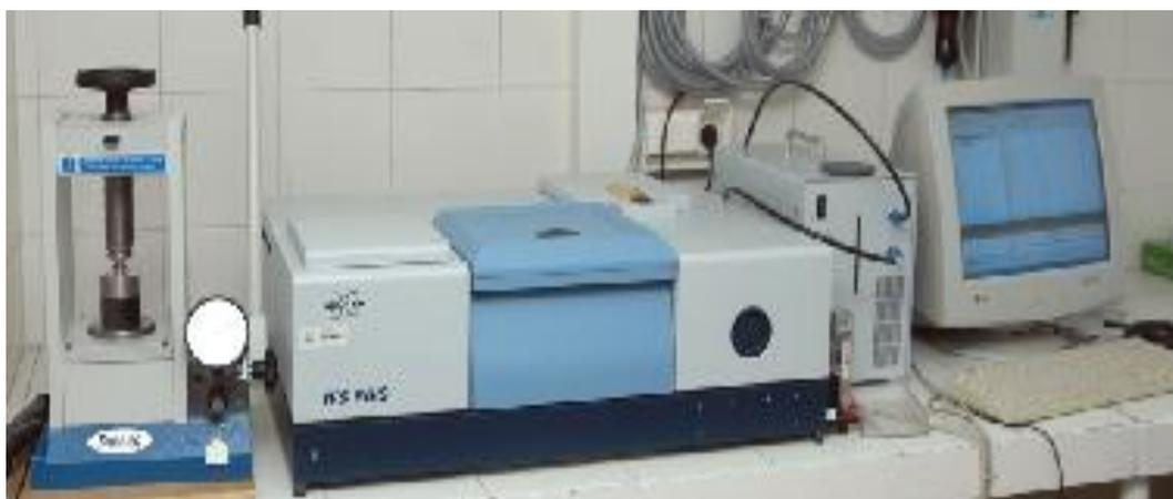
*Figure II.2. Spectromètre infrarouge à transformé de Fourier Bruker Alpha*
