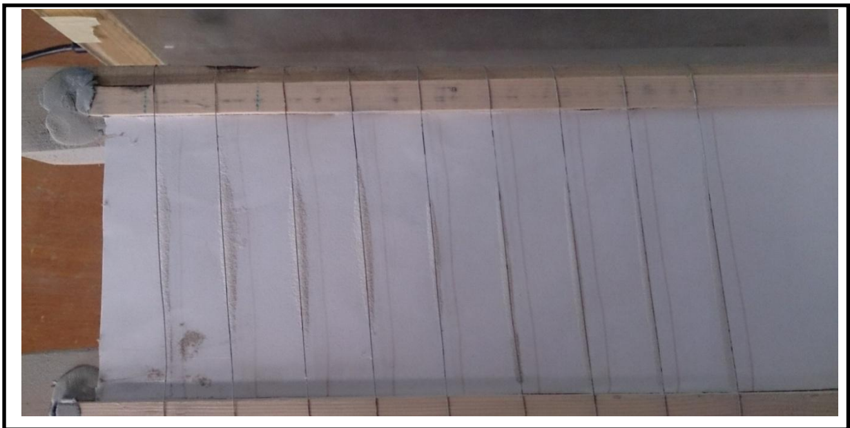
Figure III.15 Photographie rapprochée d'un dépôt de la farine sur les fils de la haute tension.
