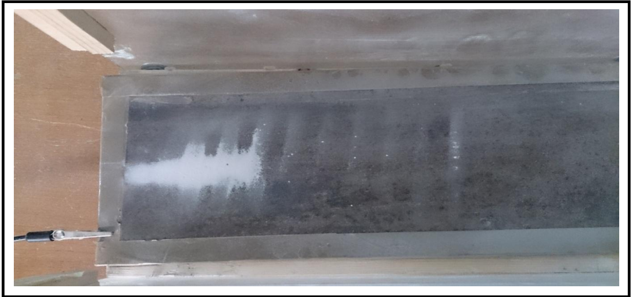
Figure III.14 Photographie d'un dépôt de la farine sur la plaque sous tension (en coupant l'injection de la farine).
