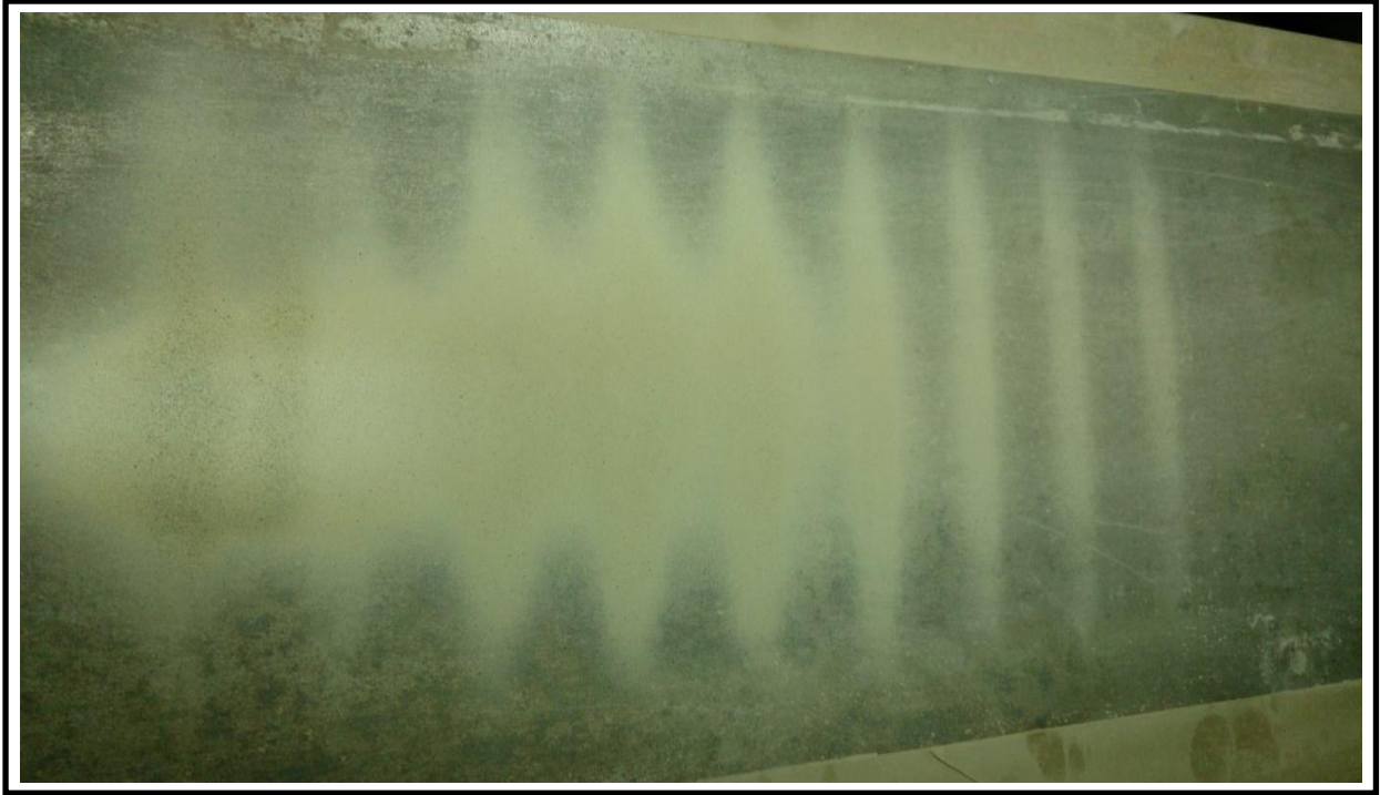
Figure III.9 Photographie d'un dépôt de poussière sur la plaque sous tension.
