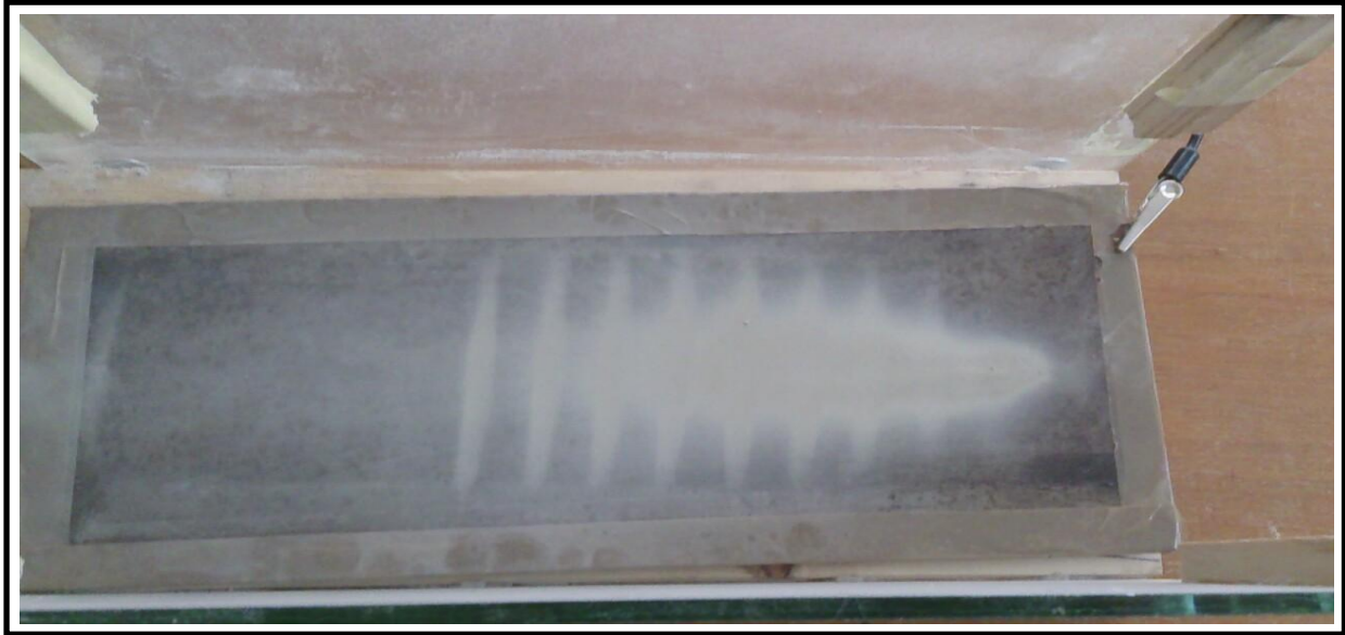
Figure III.12 Photographie d'un dépôt de la farine sur la plaque sous tension (sans arrêt de l'injection de la farine).
