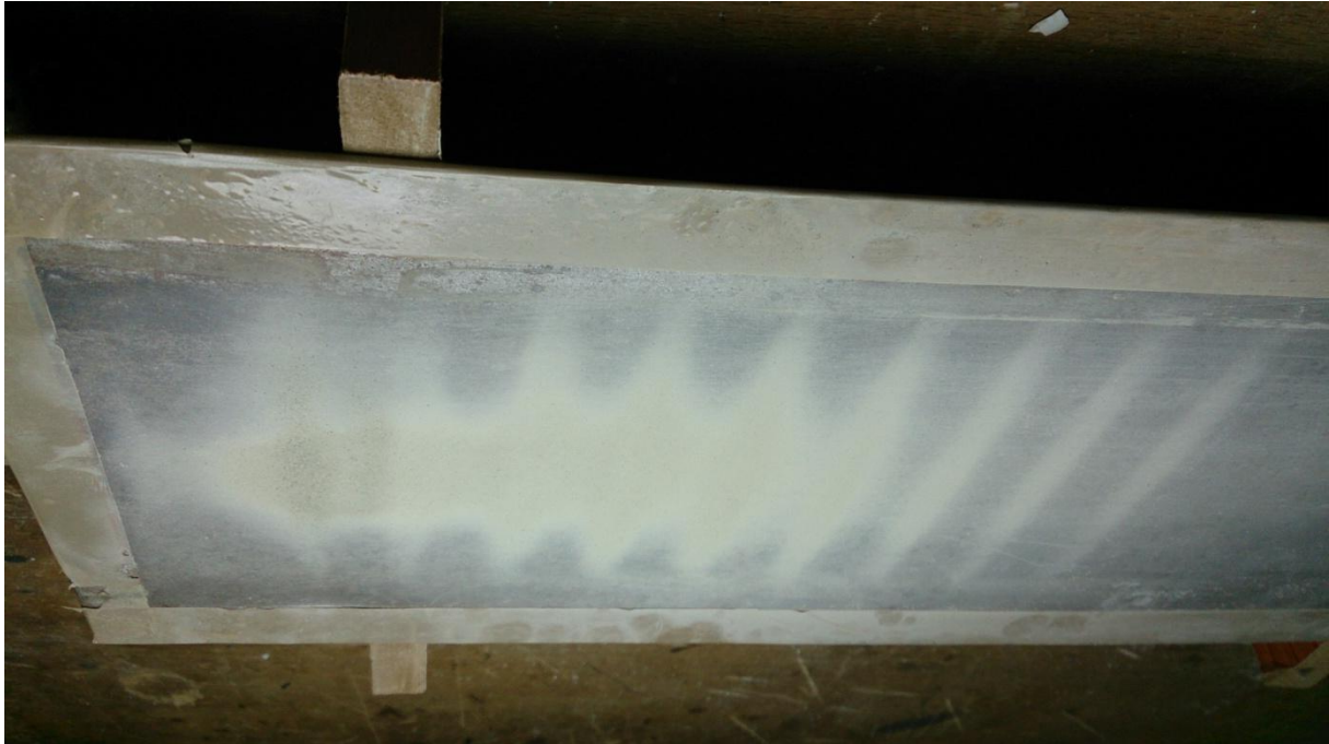
Figure III.11 Photographie d'un dépôt de poussière sur la plaque sous tension (tension plus élevée).
