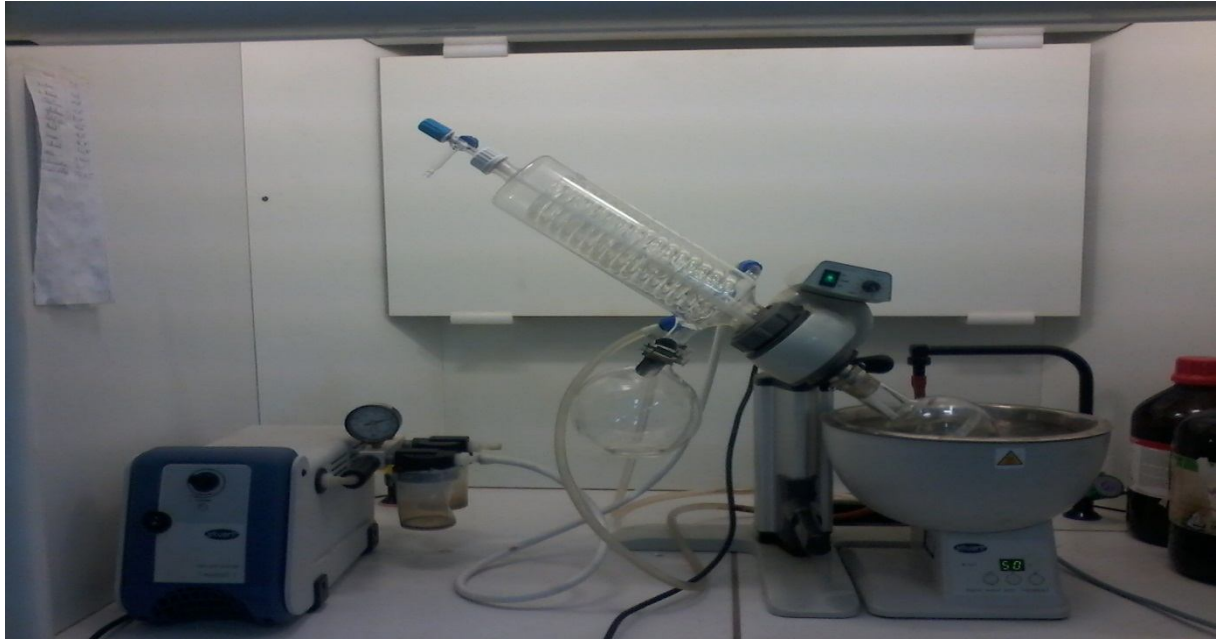
Figure 11 : évaporation sous vide par rotavapor.
