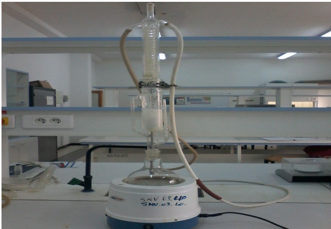
Figure 10 : Extraction des huiles de pulpe d'olive par Soxhlet.
