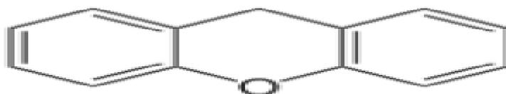
**Figure I .6 :** Structure moléculaire d'un colorant xanthène.
