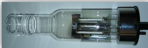
Lampe à cathode creuse : La lampe utilisée mono élément de Nickel
