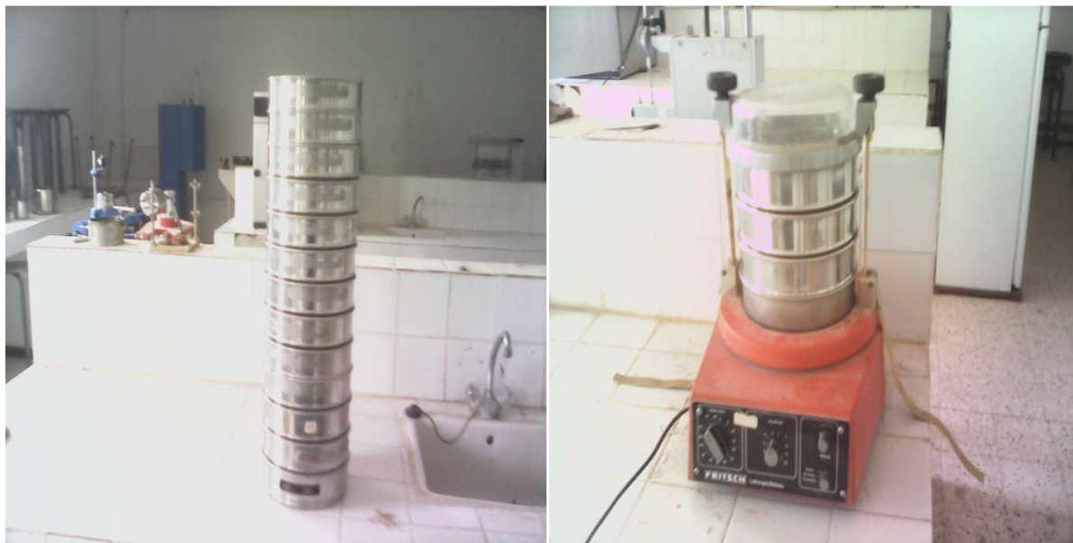
Photo II.1 : Tamisage par voie sec (de 3.2 mm a 0.075 mm)
