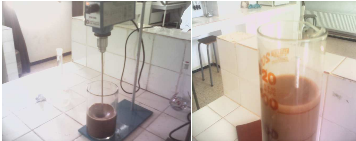
Photo II.2 : Agitation et mesure par densimètre
