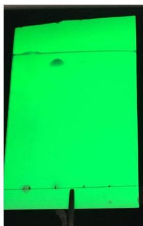
Séparation par CCM des extraits des différents échantillons de la laitue et de la pomme de terre révéler par lampe UV à 254 et 365 nm
