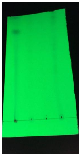
Séparation par CCM des extraits des différents échantillons du sol et d'eau révéler par lampe UV à 254 et 365 nm
