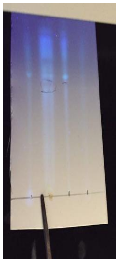
Séparation par CCM des extraits des différents échantillons du sol et d'eau révéler par lampe UV à 254 et 365 nm
