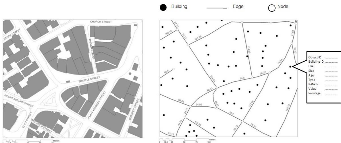
Figure 2.4. Gauche: Plan d'Harvard Square à Cambridge, MA. Droite: représentation graphique du même dessin en plan
