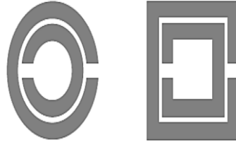
Figure I.9: Résonateur en anneau fendu (SRR) [7].
