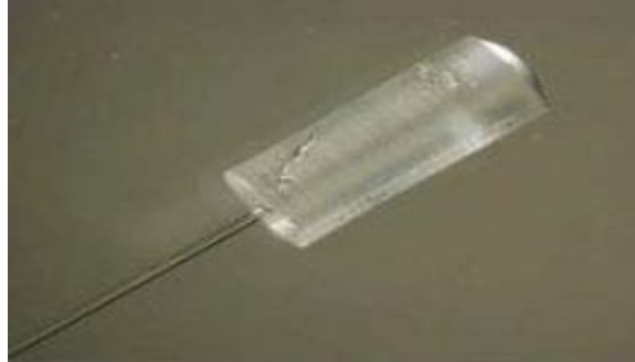
Figure 8.3. Photo d'un capteur chimique à base de fibres optiques.
