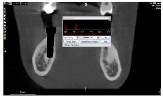
Fig. 2-11 . La méthode de retrait de l'implant de la section étudiée pour faciliter et mesurer avec précision. (Auteur).
