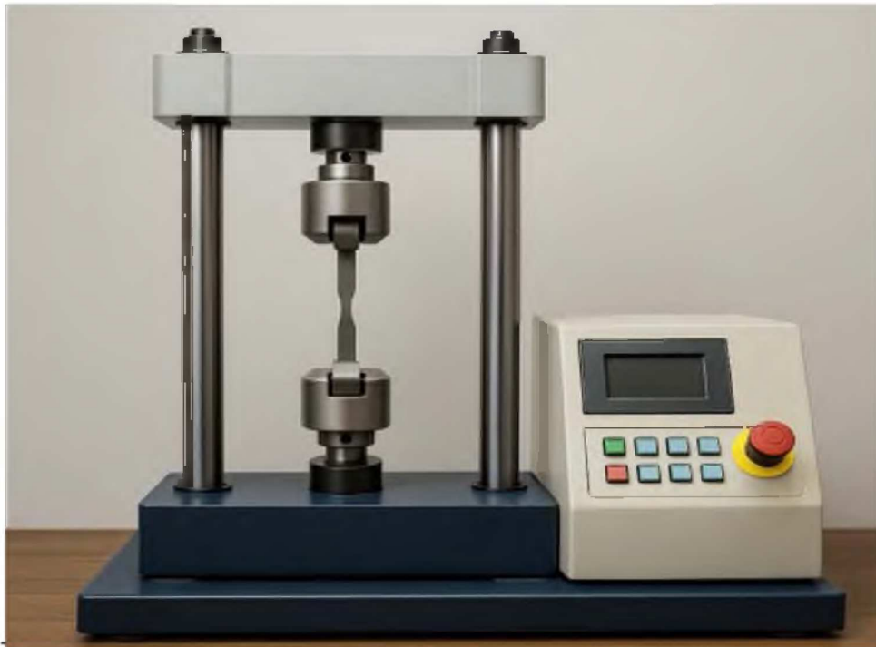
Figure III.6 : Machine de chargement–déchargement cycliques
