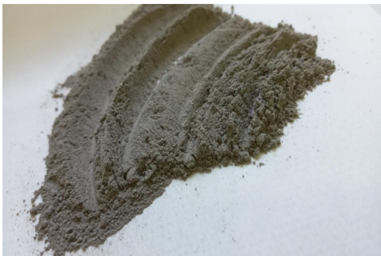
Figure II.3. L'adsorbant obtenu à partir des déchets hospitaliers incinérés.
