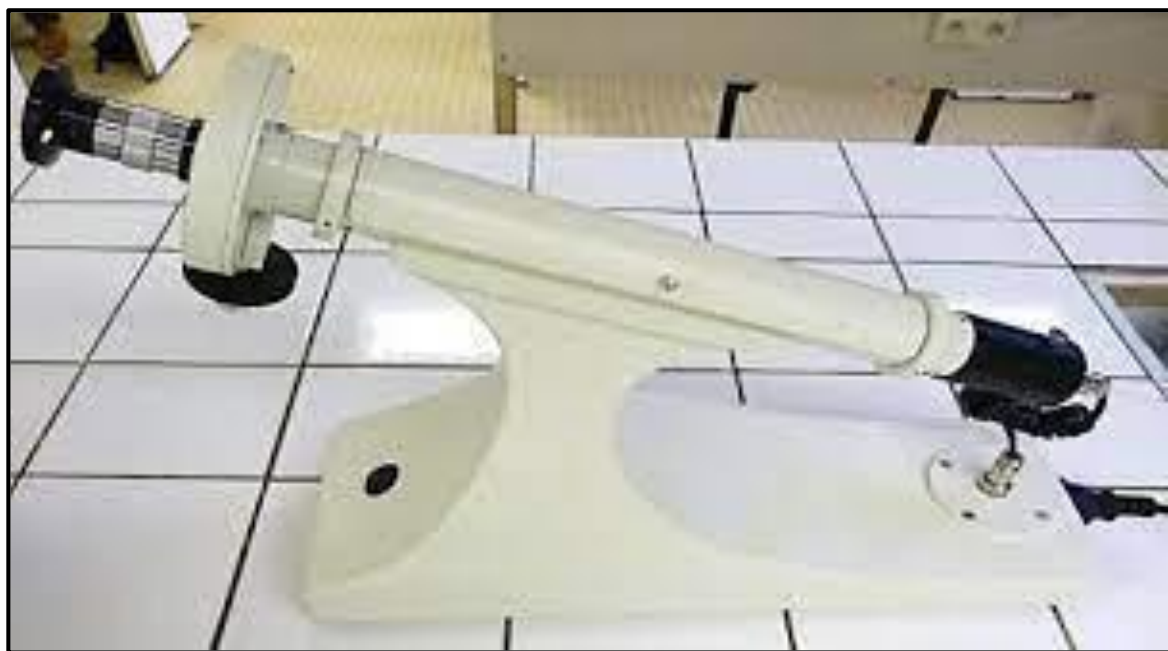
Figure 28. Polarimètre de Laurent.
