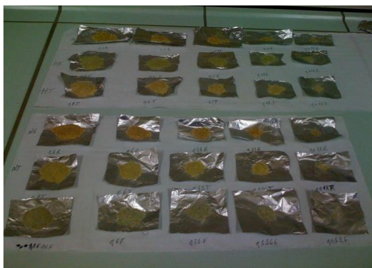
Figure 9. Poudres végétales pesés et disposés pour dilution dans de l'eau distillée.
