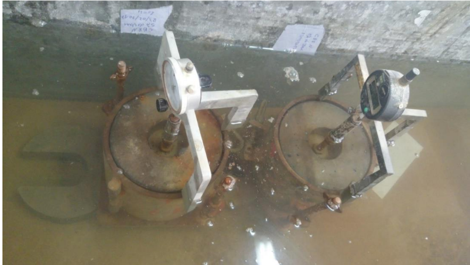
Figure III-25 : l'exécution de l'essai indice CBR après immersion (l'immersion)
