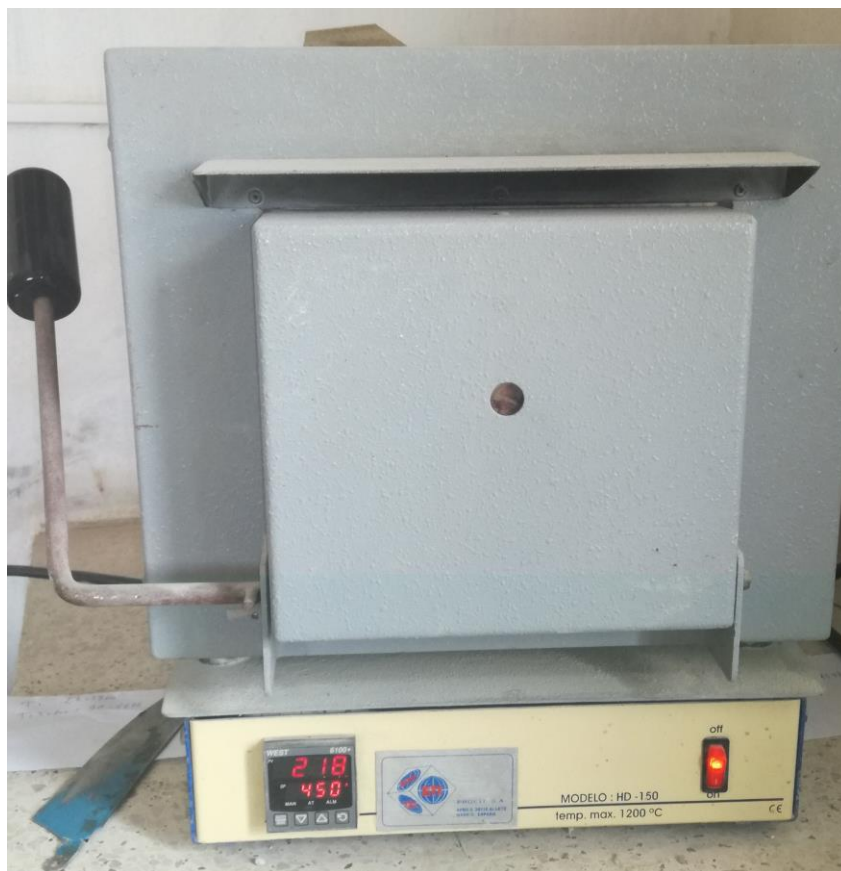
Figure III-8: Le four nécessaire pour la détermination de la matière organique
