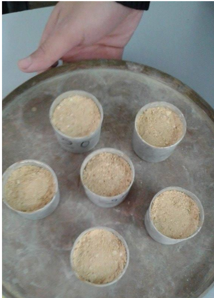
Figure III-24 : Le remplissage des échantillons représentatifs afin de déterminer de la teneur en eau
