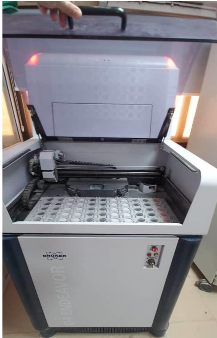
Figure III-6 : Appareil DRX (BRUKER) au niveau de Lafarge-Holcim unité Oggaz Mascara.
