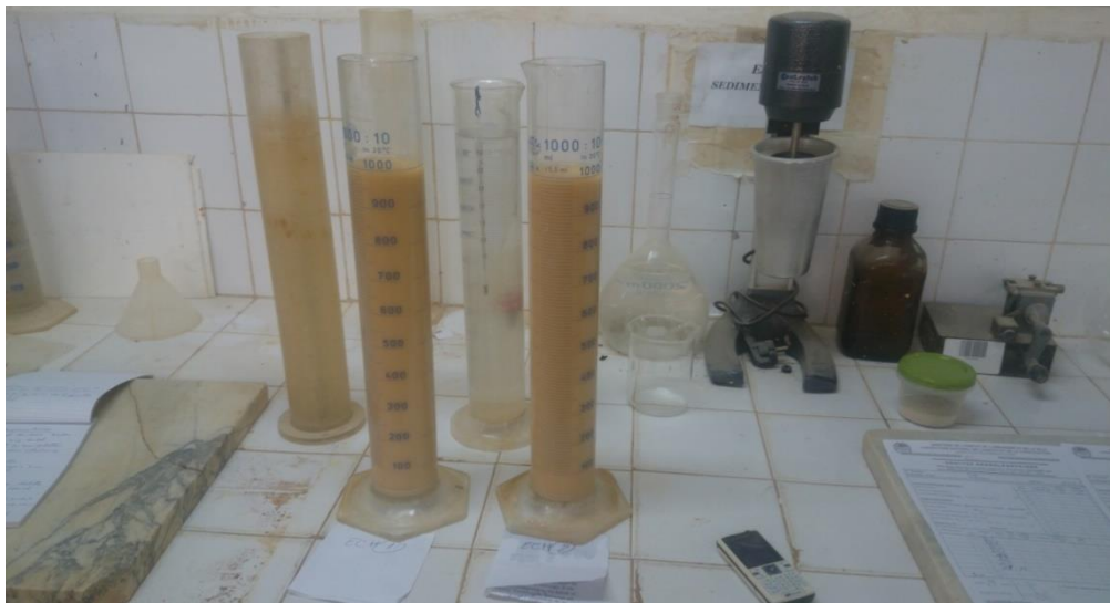
Figure III-14 : L'analyse granulométrique par sédimentométrie
