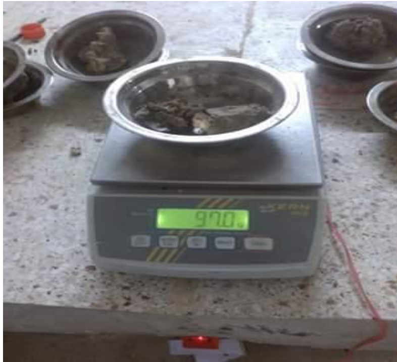
Figure III-7 : Pesée des échantillons après étuvage
