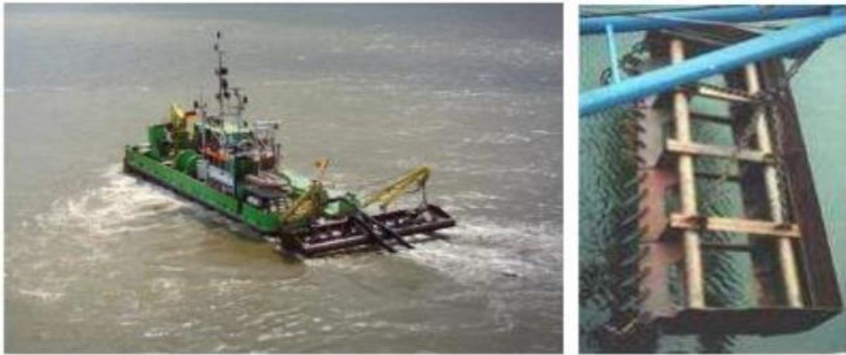
Figure I-10 : La drague à charrue Alligator et description d'une niveleuse (Geode, 2012b)
