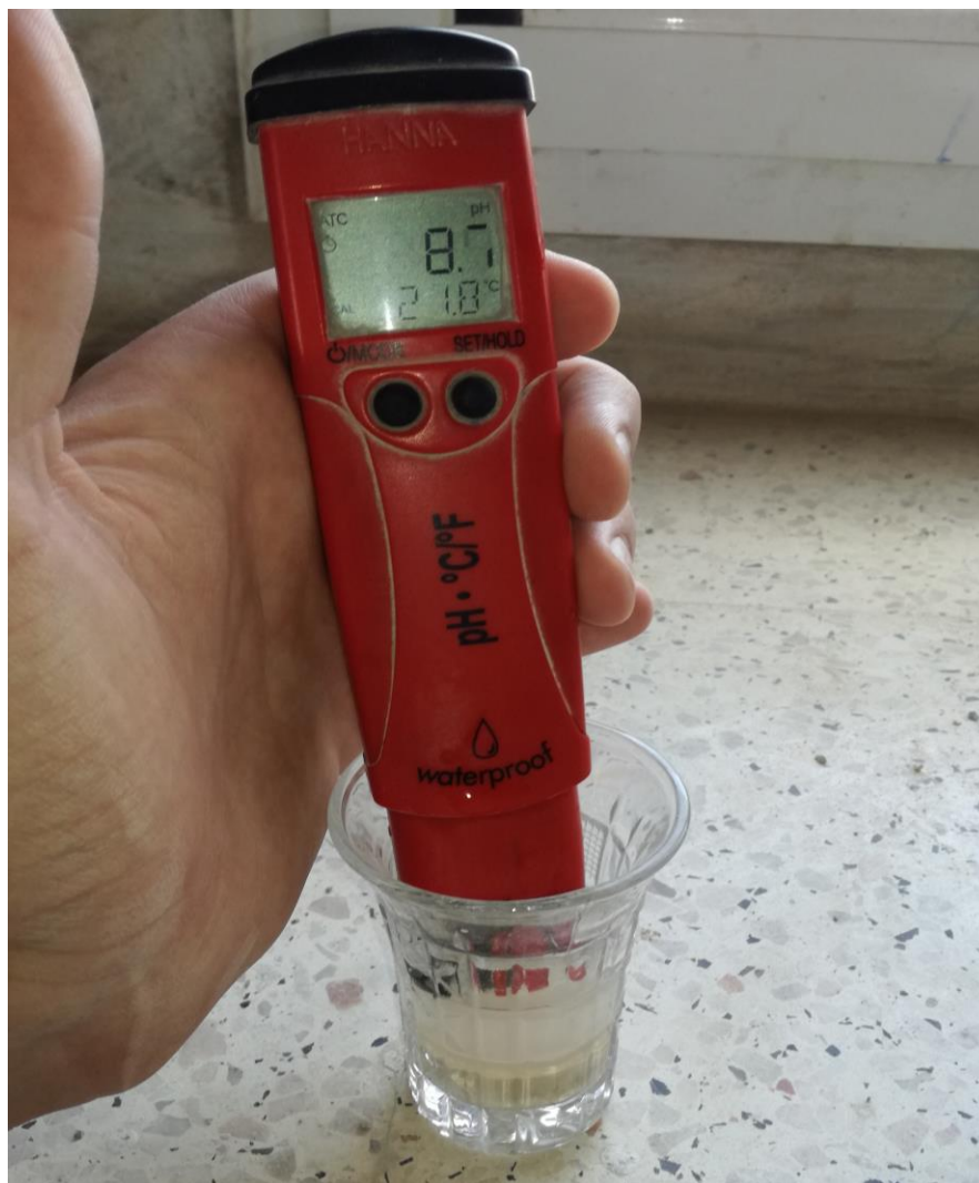
Figure III-4 : Mesure de P^H des vases selon la norme ISO 10390 (2005).
