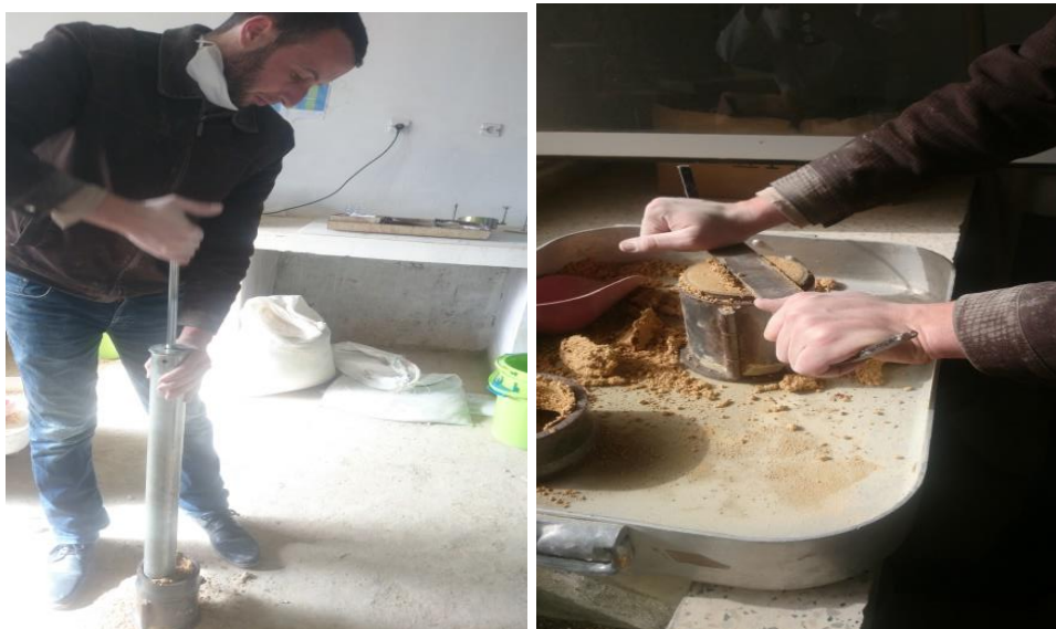
Figure III-22 : Exécution de l'essai Proctor
