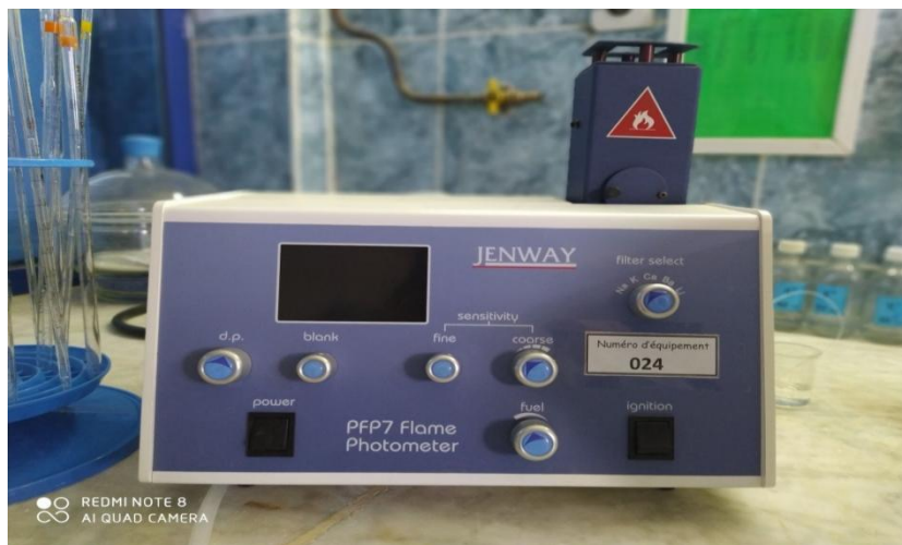
Figure 10 : Dosage du sodium spectrophotomètre en flamme
