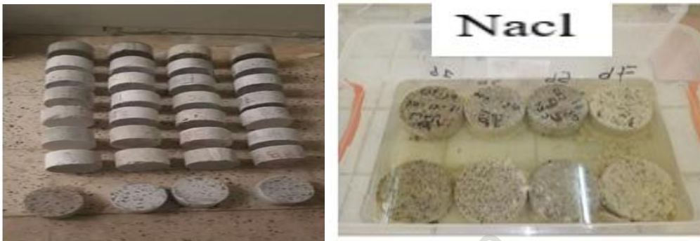
Figure 5.1. Cure agressive 10% de (NaCl). [Labo de G.C.UNIV. MASCARA]
