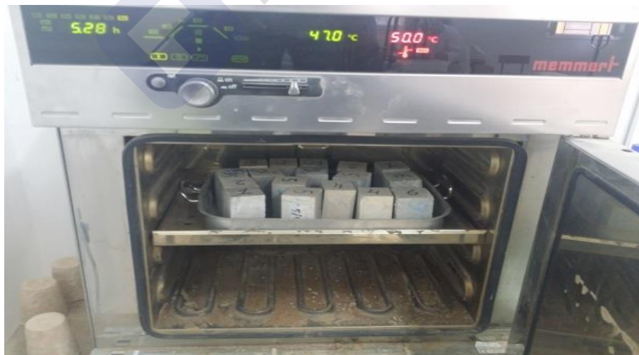
Figure 2.1 Séchage des éprouvettes en étuve à 105 °C avant l'essai d'absorption capillaire. [Labo de G.C.UNIV. MASCARA]
