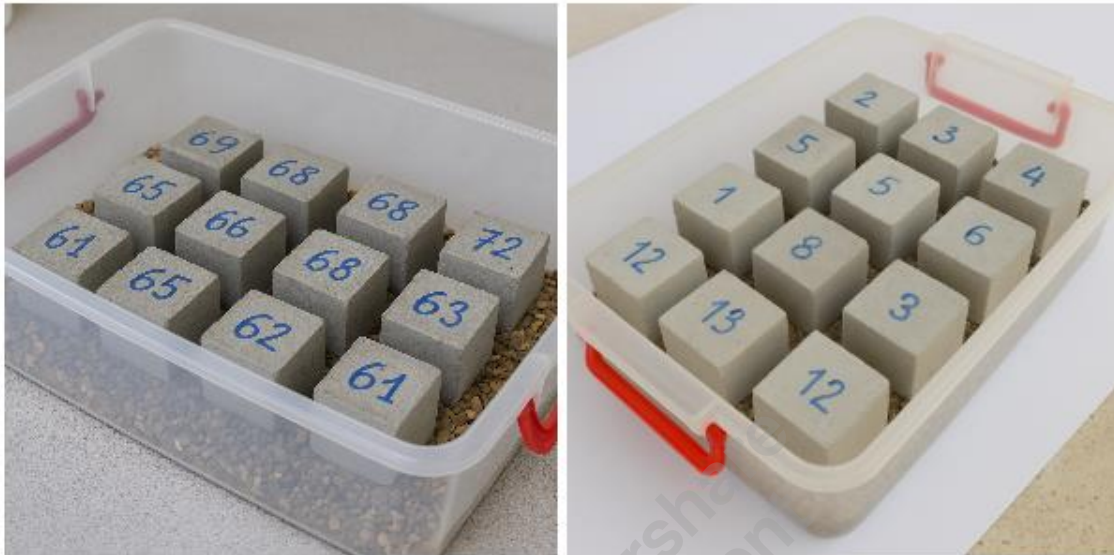
Figure 2.2 Méthodologie d'immersion des éprouvettes en mortier. [Labo de G.C.UNIV. MASCARA]
