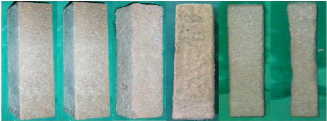
Figure 4.1 Evolutions de dégradation des éprouvettes en mortier de ciment dans des milieux acides. [Labo de G.C.UNIV. MASCARA]
