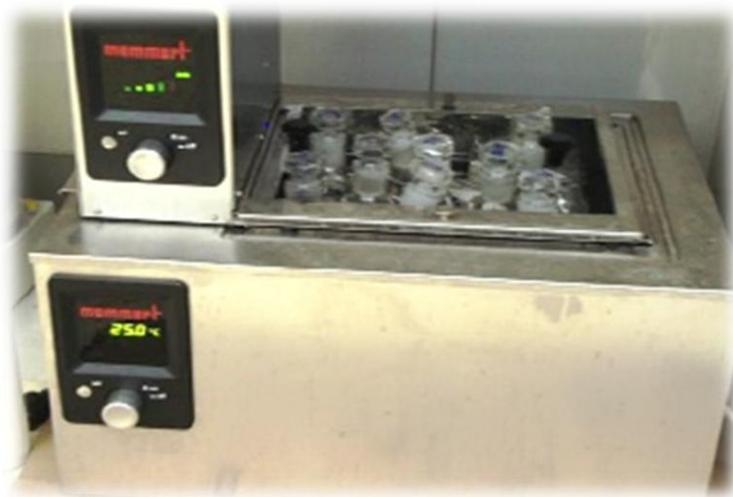
**Figure II.12 : Expérience d'Adsorption (Polluant/adsorbant)**
