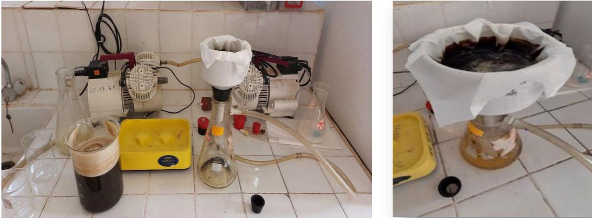
**Figure II.3 : La séparation par la filtration sous vide**
