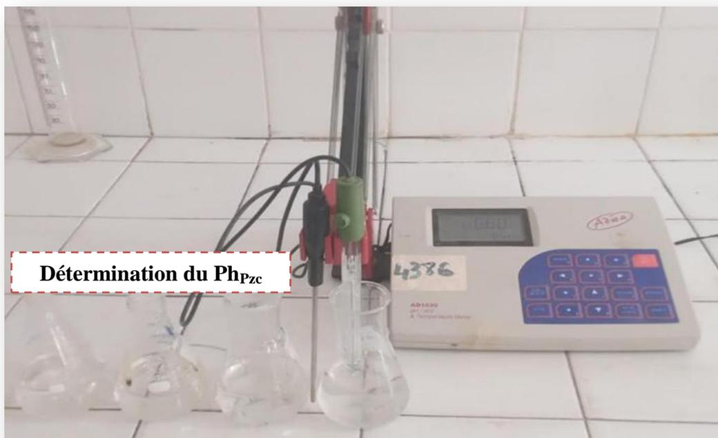
Figure II.8 : Détermination du  $pH_{pzc}$
