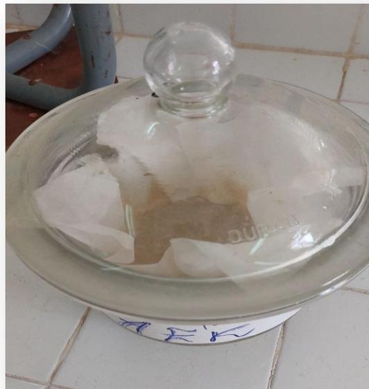
**Figure II.4 : Le séchage des boues dans un dessiccateur**
