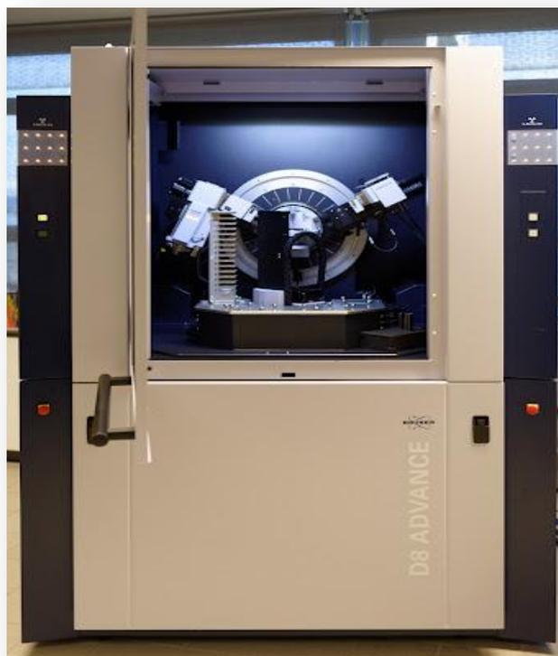
**Figure II.6 : Diffractomètre D8 Advance de marque Bruker**
