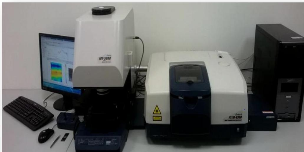
**Figure II.7 : Spectroscopie Infrarouge à Transformée de Fourier de marque (JASCO FTIR-6300)**
