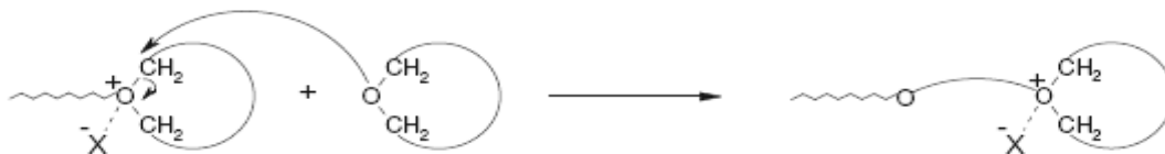
Schéma.1: Propagation par le mécanisme de la « fin de chaîne activée ».
