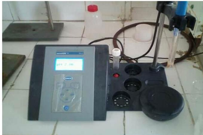
**Figure III-3** : Mesure de PH de la solution avec PH-mètre.
