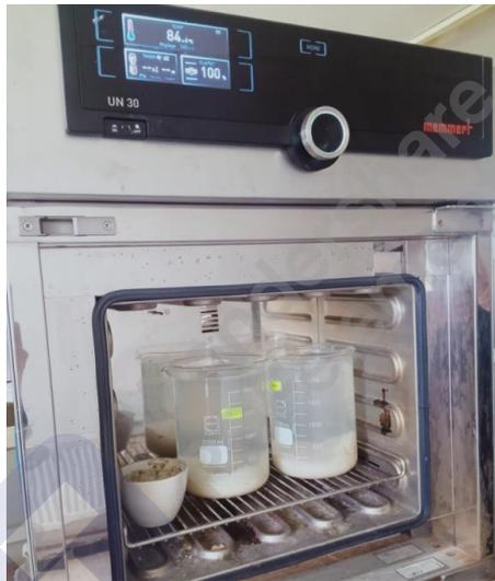
**Figure III.4** Le séchée à l'étuve à 110 °C de l'argile purifiées
