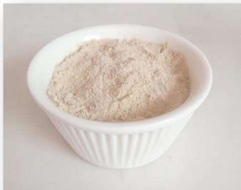
**Figure III.5** Argile purifiées (Na-Montmorillonite)
