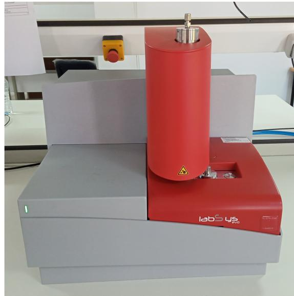
*Figure II.7: Analyseur ATG LABSYS evo*
