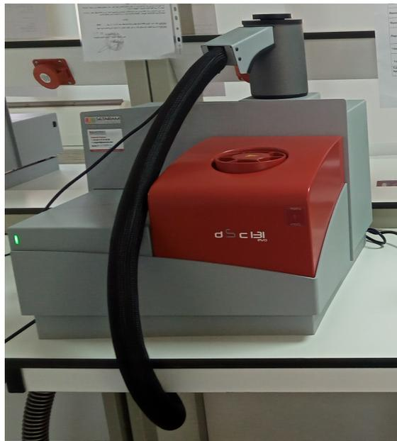
*Figure II.6: Analyseur DSC 131 evo*
