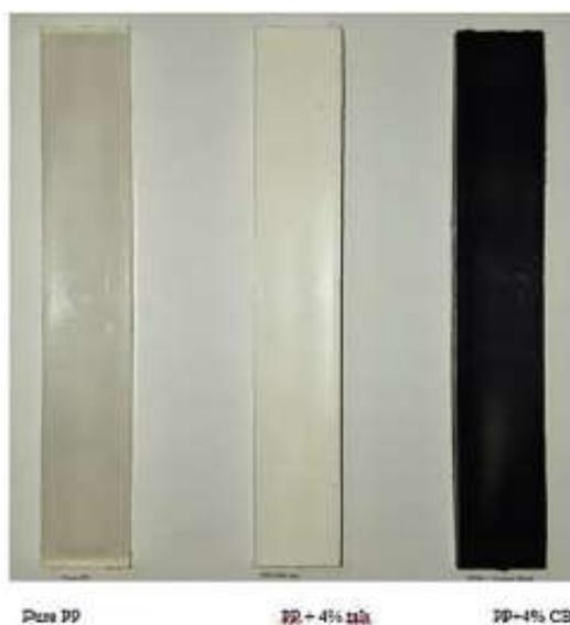
*Figure II.1.b: Echantillons de micro-composites*
