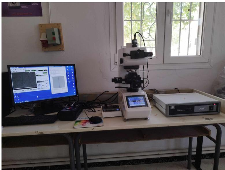
*Figure III.13 : Microduromètre FM-ARS9000*
