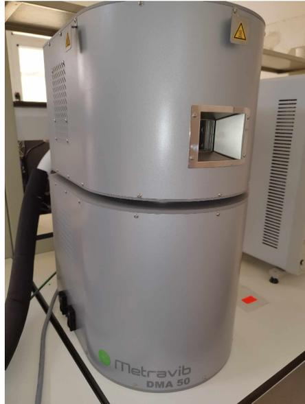
*Figure II.8: Analyseur METRAVIB DMA 50*
