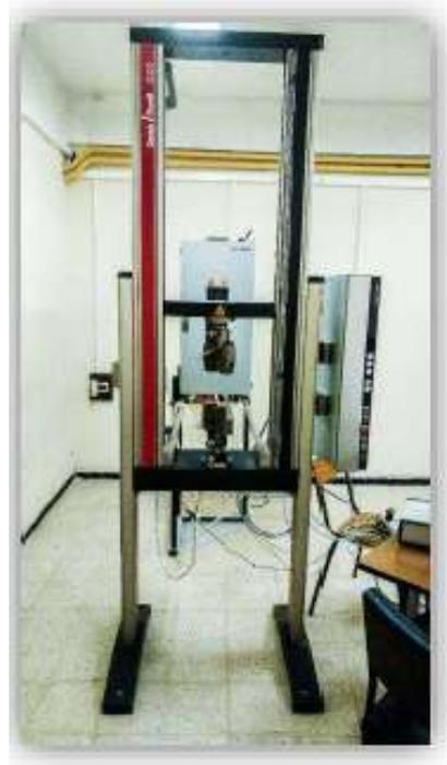
*Figure III.1* Machine de traction Zwick- Roller
