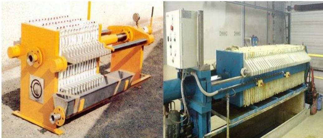
**Figure 43 :** Filtration par filtre presse.
