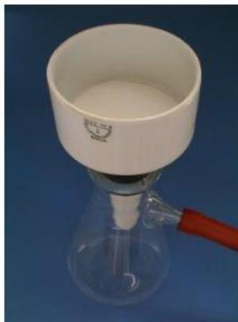
**Figure 42** : Filtration sous vide par Büchner.
