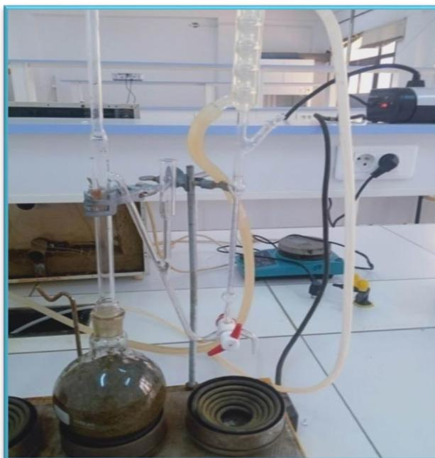
**Figure 23:** Photo, extraction des huiles essentielles par hydrodistillation
