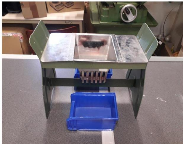
Figure III-4. Diviseur d'échantillons Retsch Riffelteiler type 6.5.
