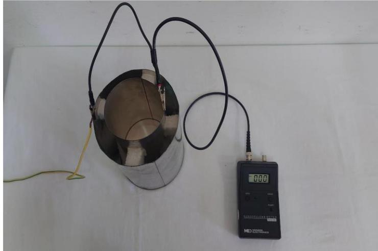
Figure II-7. Configuration de la cage de Faraday et du NanoColumb Meter.
