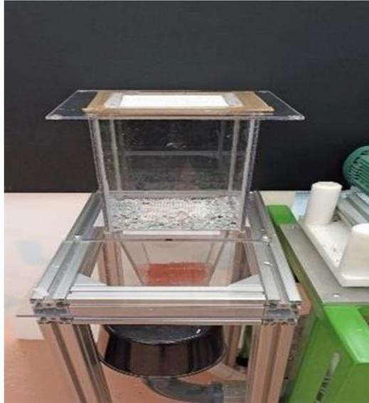
Figure III-3. Dispositif de chargement électrique à lit fluidisé.
