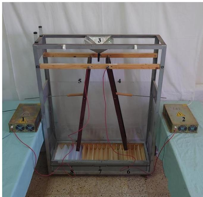
Figure II-3. Séparateur à chute libre. 1 : Alimentation HT (-) ; 2 : Alimentation HT (+) ;
