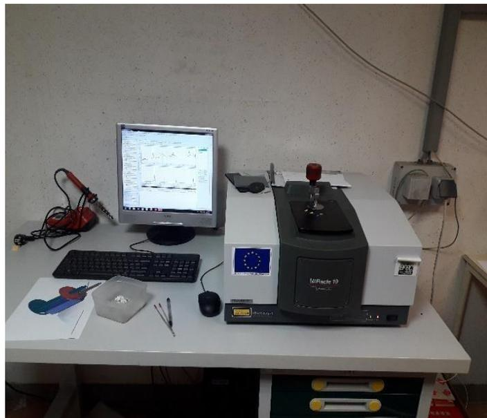
Figure III-5. Dispositif d'analyse IRAffinity-1S.
