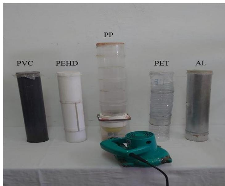
Figure II-1. Dispositif de chargement triboélectrique à lit fluidisé.
