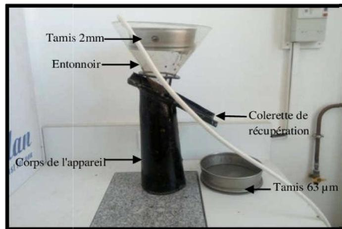
**Figure 8 :** Appareil de Fenwick (Originale 2019).
