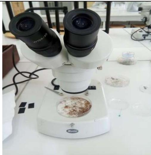
**Figure10** : Récupération des kystes de *Globodera Sp.* Sous une loupe binoculaire. (Originale 2019)
