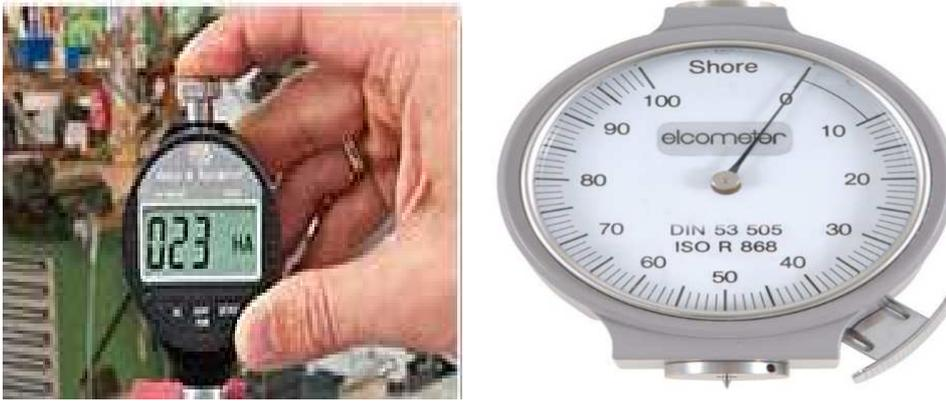
Fig.I.9. Les duromètres numériques et analogiques [31].
