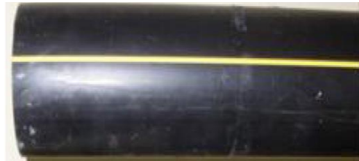
Fig.III.3. Échantillon de tuyau en PEHD utilisé dans les expériences.
