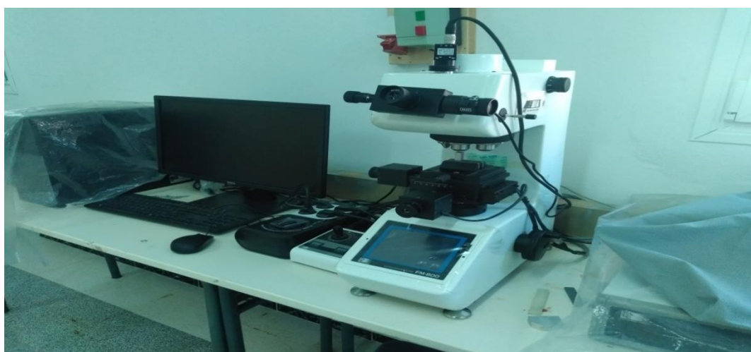
Fig. III.11 : dispositif pour essai de micro-dureté piloté par ordinateur, avec acquisition d'images, ce qui permet de faire des cartes ou des profils automatiques de micro-dureté.
