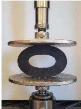
Fig. IV.1. Compression d'un tube cylindrique en élastomère.
