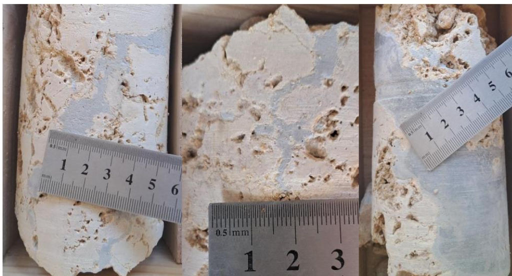
Figure V-73: Présence de coulis d'injection dans des fissures centimétriques, millimétriques et microfissures des calcaires vacuolaires.
