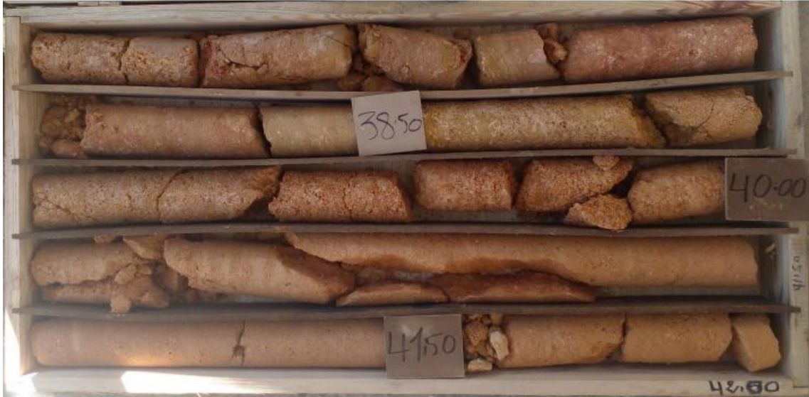
Figure IV-12: Photographie des caisses de carottes dans le forage n°1 à la profondeur de 38-42 m.
