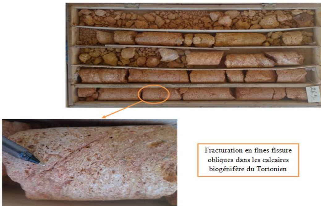
Figure IV-11: Photographie des caisses de carottes dans le forage n°1 à la profondeur de 24-26,5 m.
