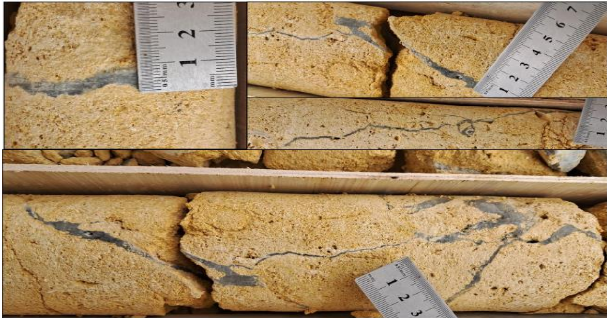
Figure V-74: Pénétration du coulis de ciment dans les fissures.
