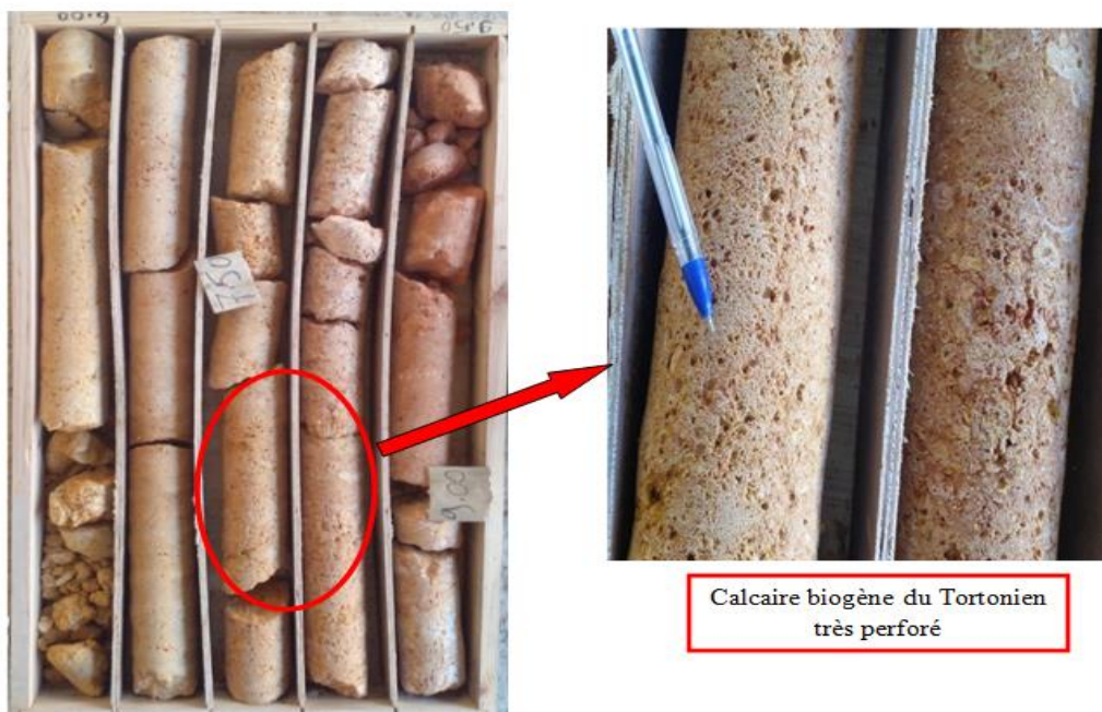
Figure IV-18: Photographie des caisses de carottes dans le forage P3 à la profondeur de 4-9 m.
