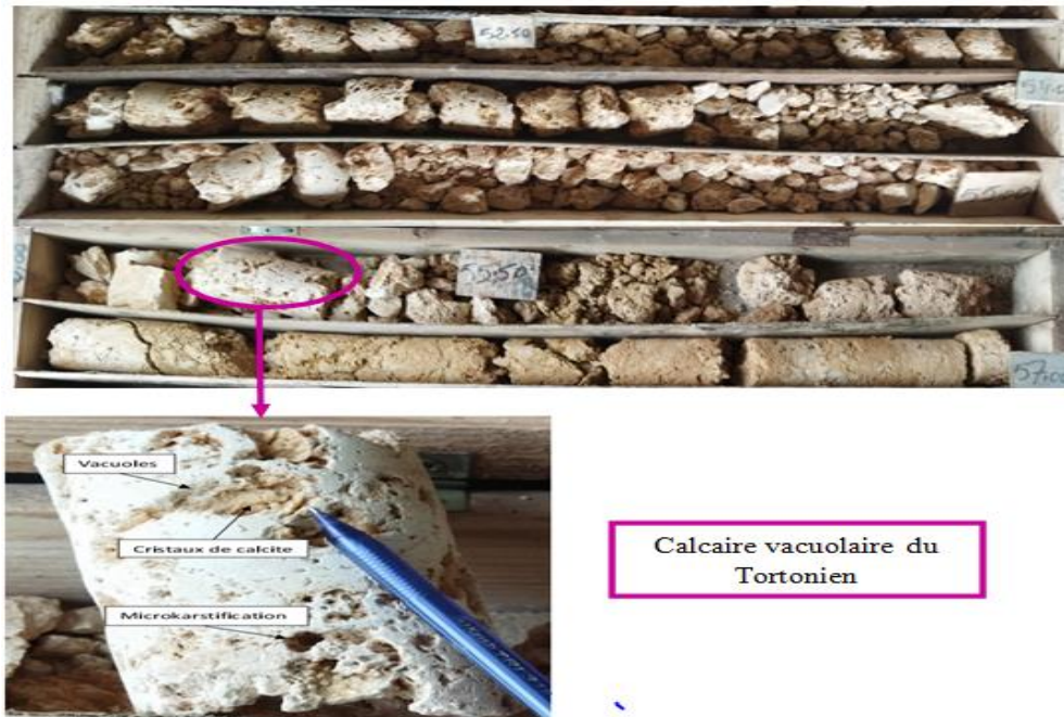
Figure IV-24: Photographie des caisses de carottes dans le forage P1 à la profondeur de 52-57 m.
