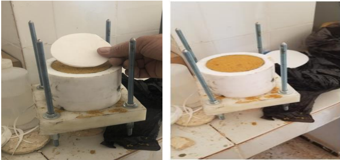
Figure IV-50: Mise en place de la couche de sable et des papiers filtre (03/2022).
