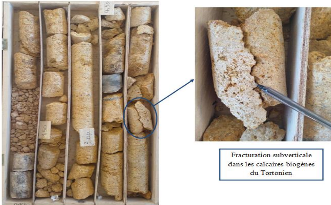
Figure IV-9: Photographie des caisses de carottes au niveau de la rive droite dans le forage n°1 à la profondeur de 5,8 m (ANBT, 2022 ; Geomag, 2022)
