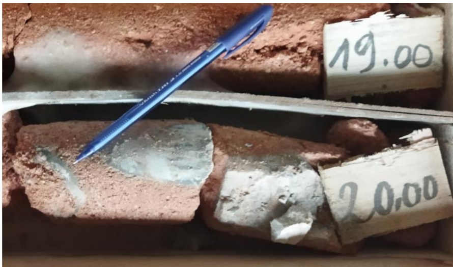
Figure V-56: Pénétration du coulis d'injection et interaction avec les grès.
