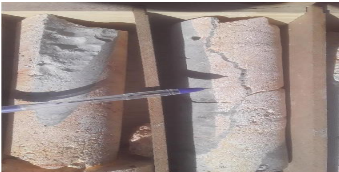
Figure V-32: Pénétration et imprégnation du coulis d'injection dans les fissures millimétriques.
