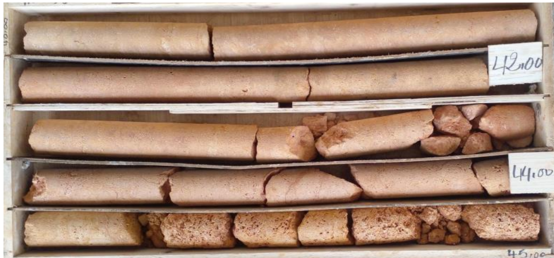
Figure IV-15: Photographie des caisses de carottes dans le forage P2 à la profondeur de 40-45 m.
