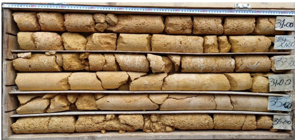
Figure IV-29: Photographie des caisses de carottes dans le forage PRG-03 à la profondeur de 31-36 m.
