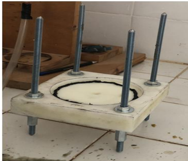
Figure IV-51: Mise en place d'un joint pour renforcer l'étanchéité du système (03/2022).
