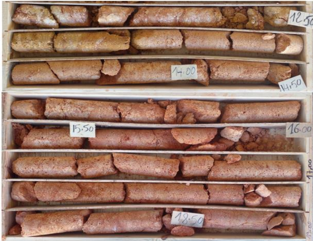
Figure IV-19: Photographie des caisses de carottes dans le forage P3 à la profondeur de 12-19 m.
