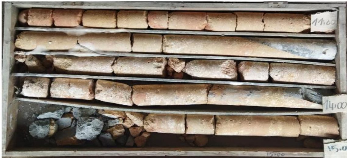
Figure V-55: Remplissage des vides par le coulis d'injection.
