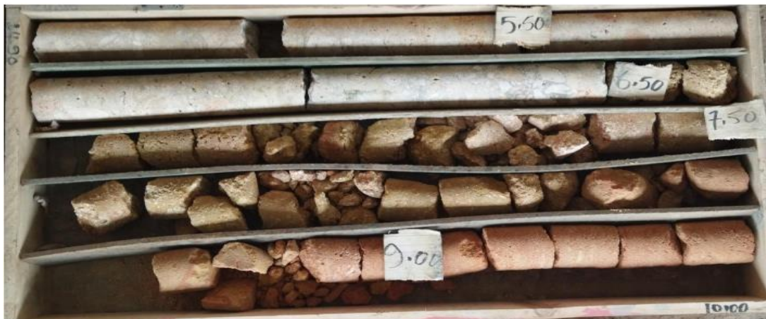
Figure IV-22: Photographie des caisses de carottes dans le forage P1 à la profondeur de 5-10 m.
