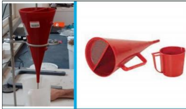
Figure V-3: Cône de Marsh (Mesure de la viscosité).
