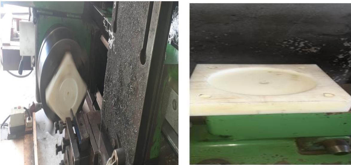
Figure IV-47: Ré-usinage des rainures (03/2022)
