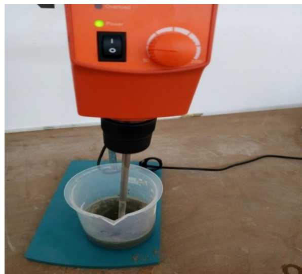
L'agitation de mélange ciment+eau
