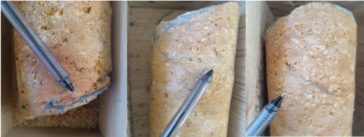
Figure V-29: Traces de coulis d'injection dans les fissures des roches dans le plot I.
