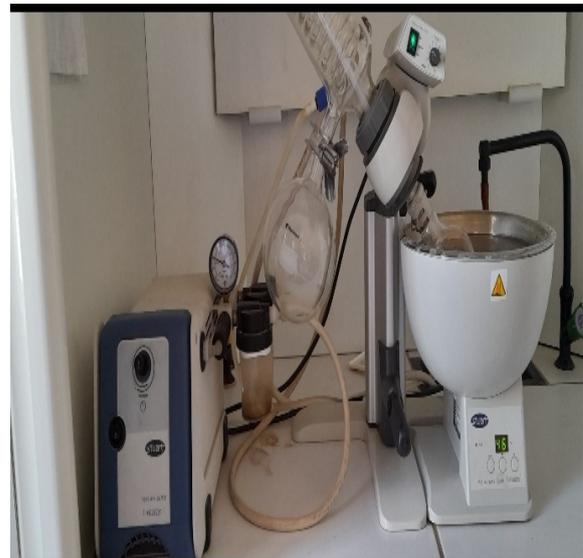
Figure 91 : évaporation à sec au rotavapor des extraits de fraise
