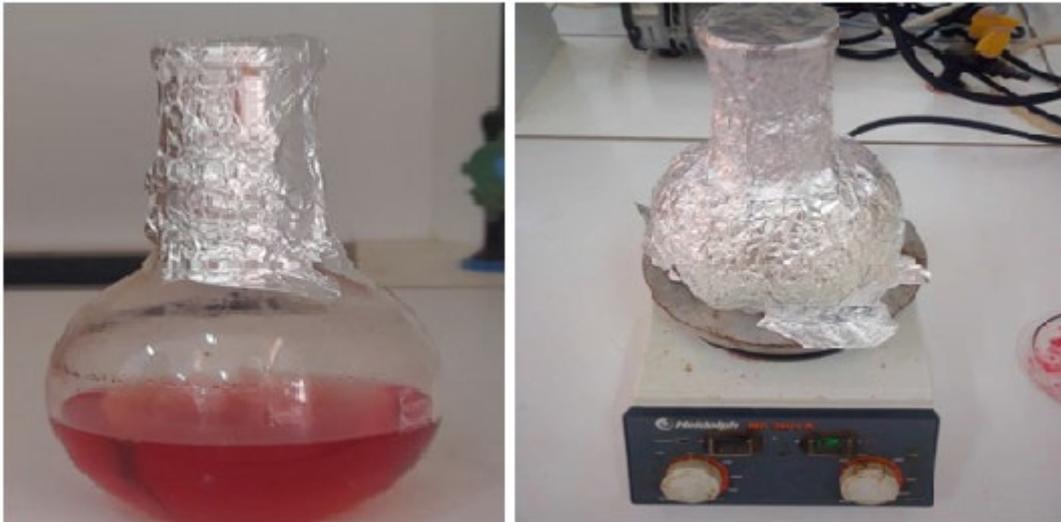
**Figure 88** : dispositif d'extraction solide – liquide par simple macération
