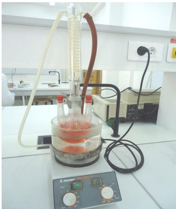
**Figure 60** : Montage d'un système de chauffage à reflux.
