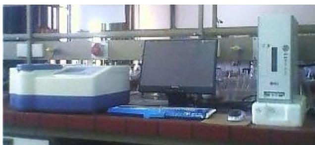
**Figure 100** : Spectrophotomètre d'absorption UV-Visible
