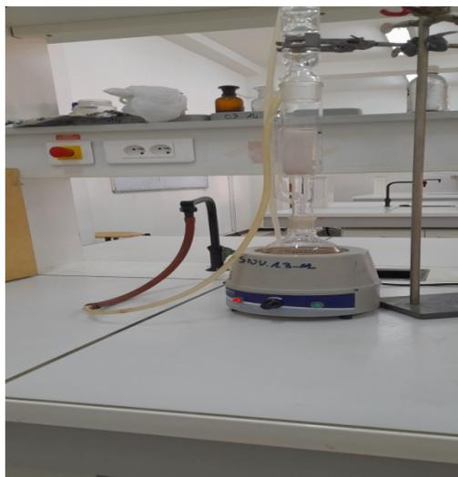
Figure 92 : Extraction par Soxhlet des extraits de la fraise
