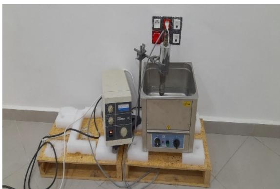
Figure 93 : Montage de dispositif de l'extraction par sonication
