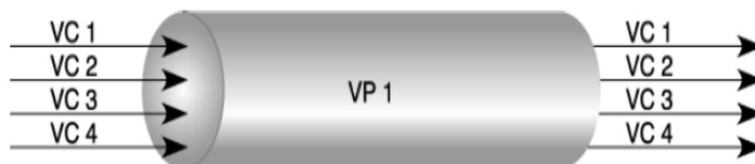
**Figure 3.31.** Multiplexage des VC et des VP
