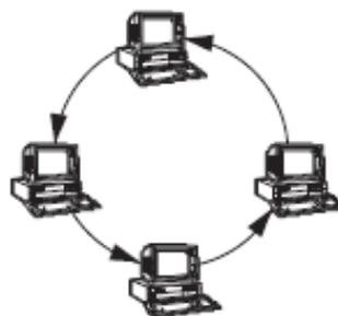
**Figure 2.4.** Principe de l'anneau.
