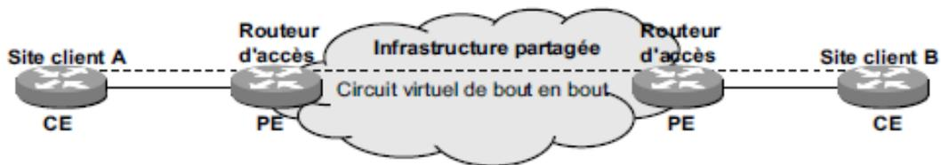
**Figure 5.13.** Principe du modèle *overlay*.
