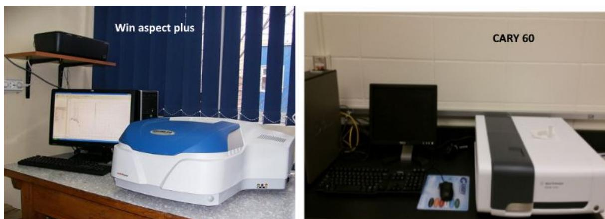
**Figure. 09** : les spectroscopies UV-Vis Win Aspect Plus et CARY 60
