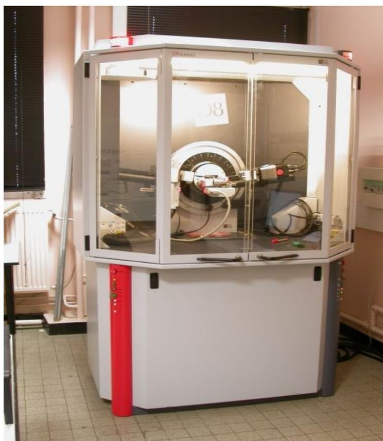
**Figure. 07 :** Diffractomètre de rayon X
