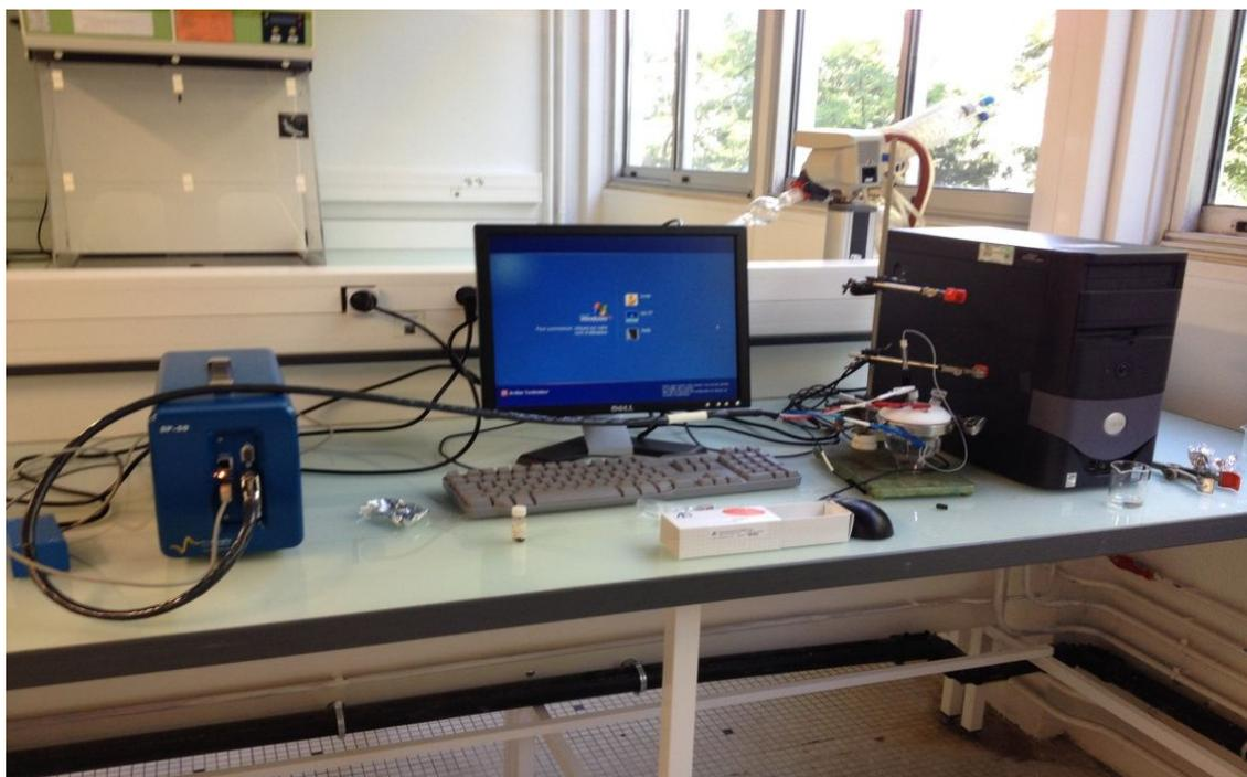
**Figure 11.** Montage utilisé lors des mesures de voltampérométrie cyclique.
