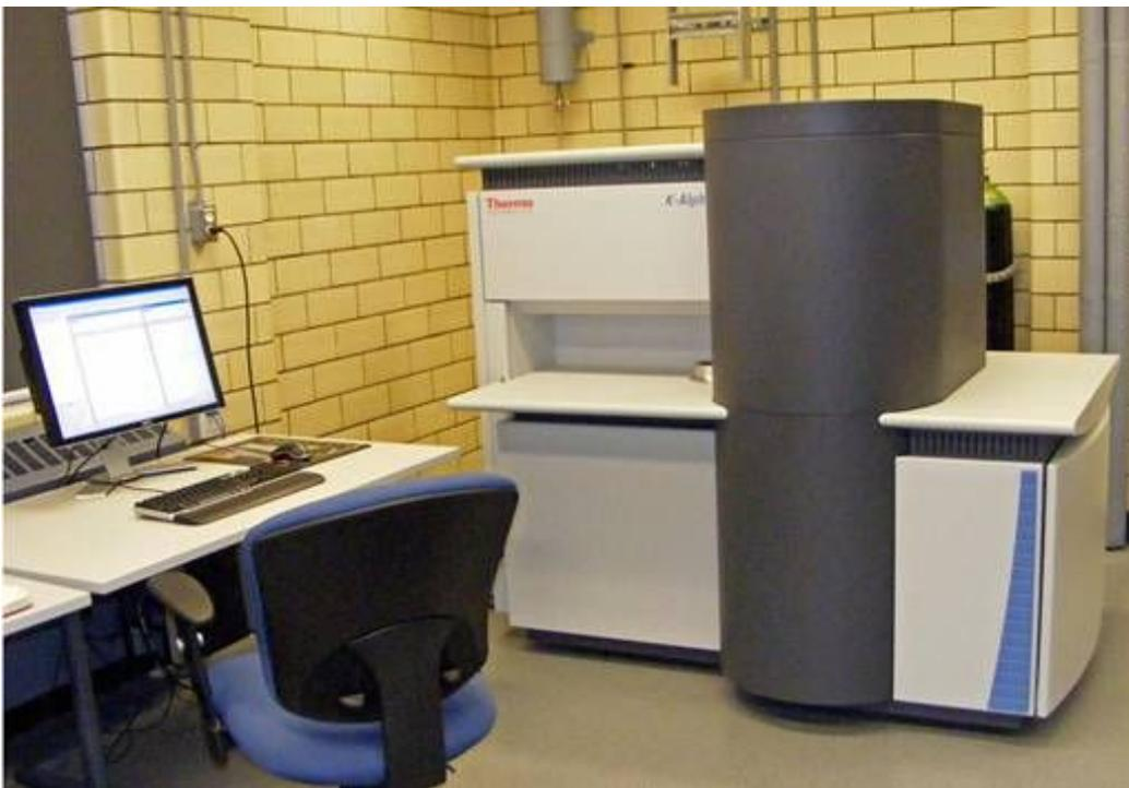
**Figure 13:** Spectromètre XPS Thermo Fisher K-alpha
