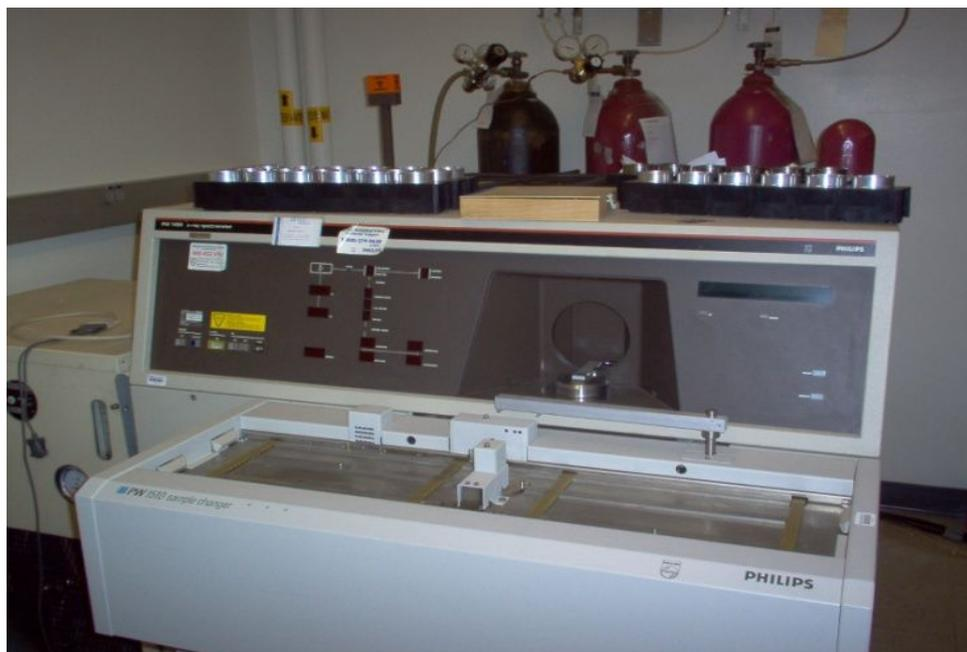
**Figure. 02** : Le spectromètre FRX Philips, PW1480
