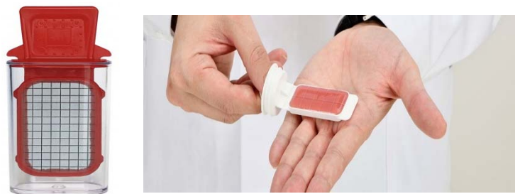
Figure 6: La lame gélosée pour contrôle des surfaces
