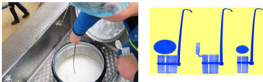
Figure 10 : L'équipement pour prélèvement et les récipients destinés à recevoir les prélèvements du lait
