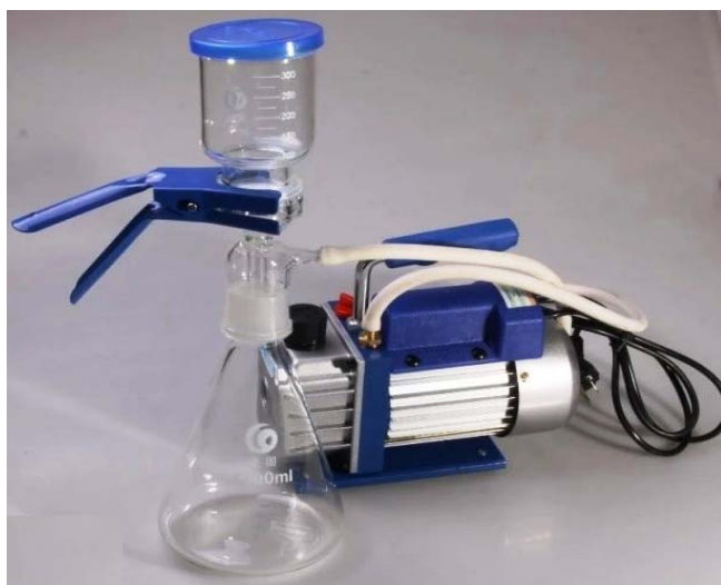
Figure 17 : Unité de filtration: dispositif pour le contrôle microbiologique des liquides grâce à une membrane de filtration.
