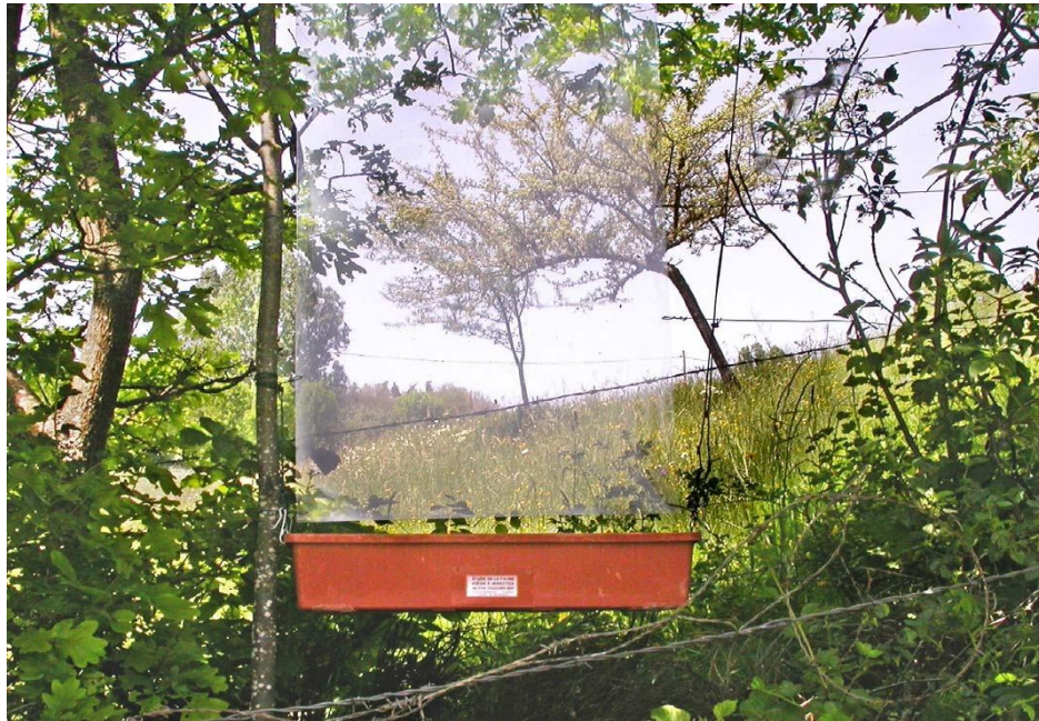
Figure (I.8) : Piège à panneau simple, suspendu à une perche horizontale dans la trouée d'une haie. [43]
