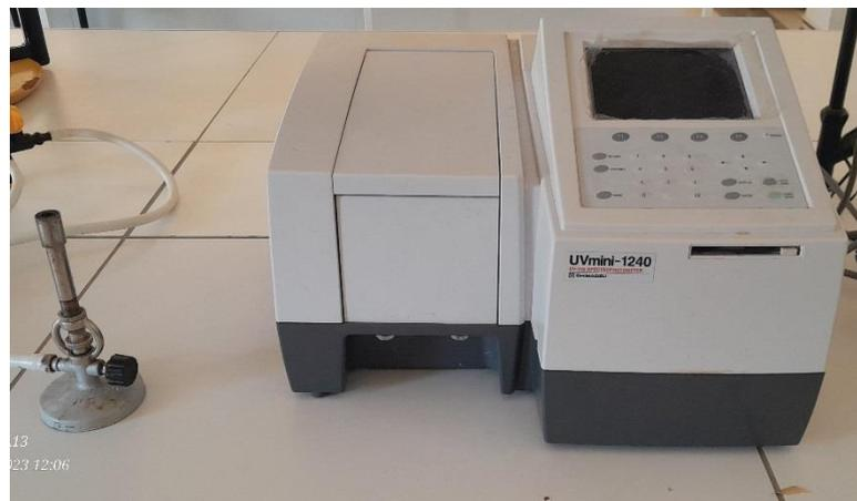
Figure 7 l'appareil d'UV- visible.
