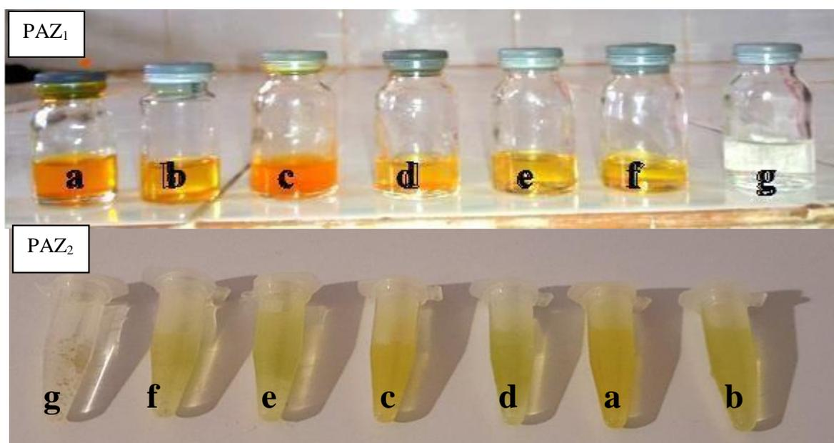
Figure 3.26 Tests de solubilité des copolymères  $PAZ_1$  et  $PAZ_2$  dans : (a) chloroforme, (b) DMF, (c)acétonitrile, (d) acétone, (e) DMSO, (f) toluène, (g) éthanol.
