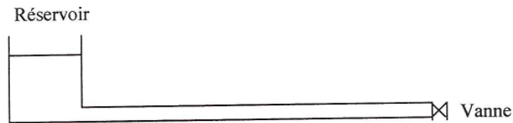
Figure II. 12. Représentation schématique d'une conduite avec réservoir
