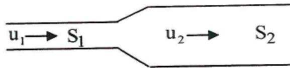
Figure II. 3: Représentations schématique d'un élargissement brusque
