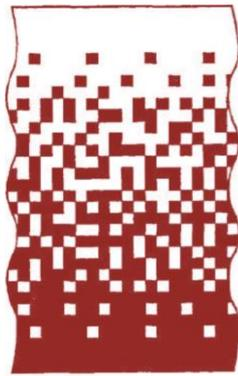
**Figure I.3** . Variation continue de la microstructure (Aboudi 1999). (schématisée)
