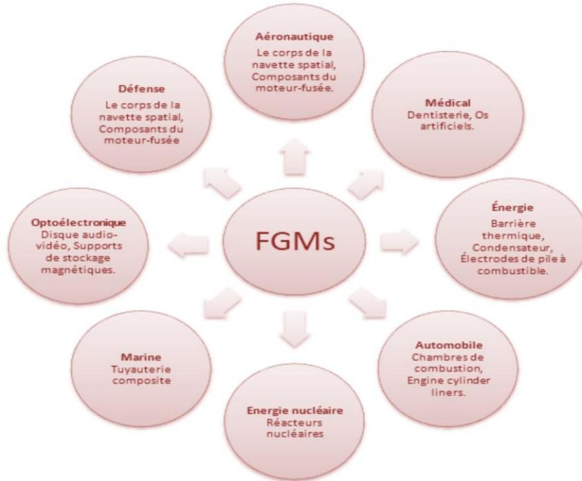
Figure I.6. Les différents domaines d’application des FGMs.
