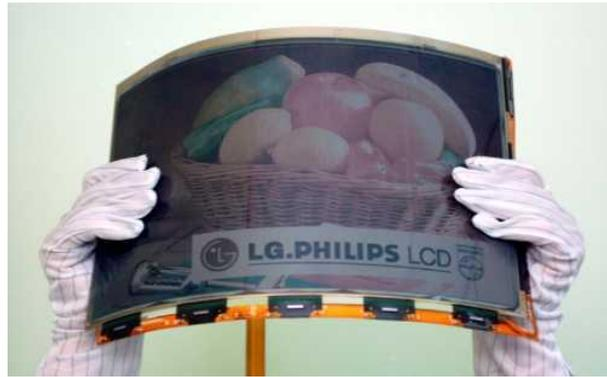
**Figure II.7.** Moniteur d'affichage couleur flexible développé par LG.Philips.
