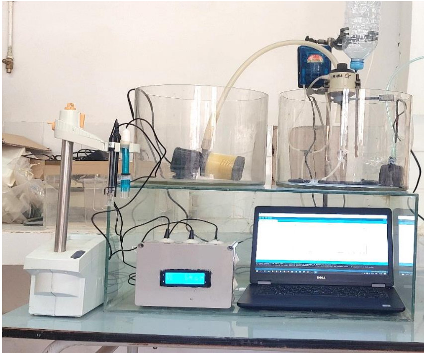
Photo II.10. Dispositif expérimentale du SBR avec moniteur Arduino
