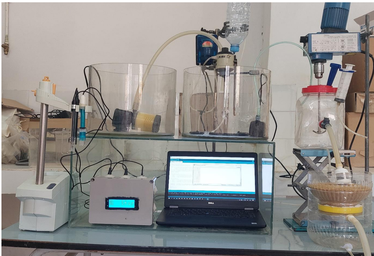
Photo II.13 : Pilote de traitement hybride (biologique + chimique)
