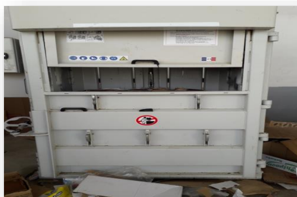
Photo III.12 : Etapes N°2 Pressage descente
