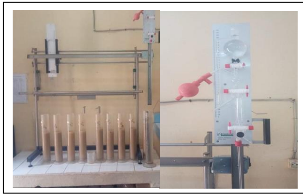
Figure 9 : Dispositif de Pipette de Robinson (Laboratoire INSID - Relizane ‘El Matmar’)
