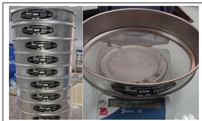
Figure 8 : Dispositif expérimental de la granulométrie par tamisage
