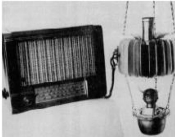
Figure I.13 : Radio alimentée par module thermoélectrique utilisant la chaleur d'une lampe à pétrole [60]
