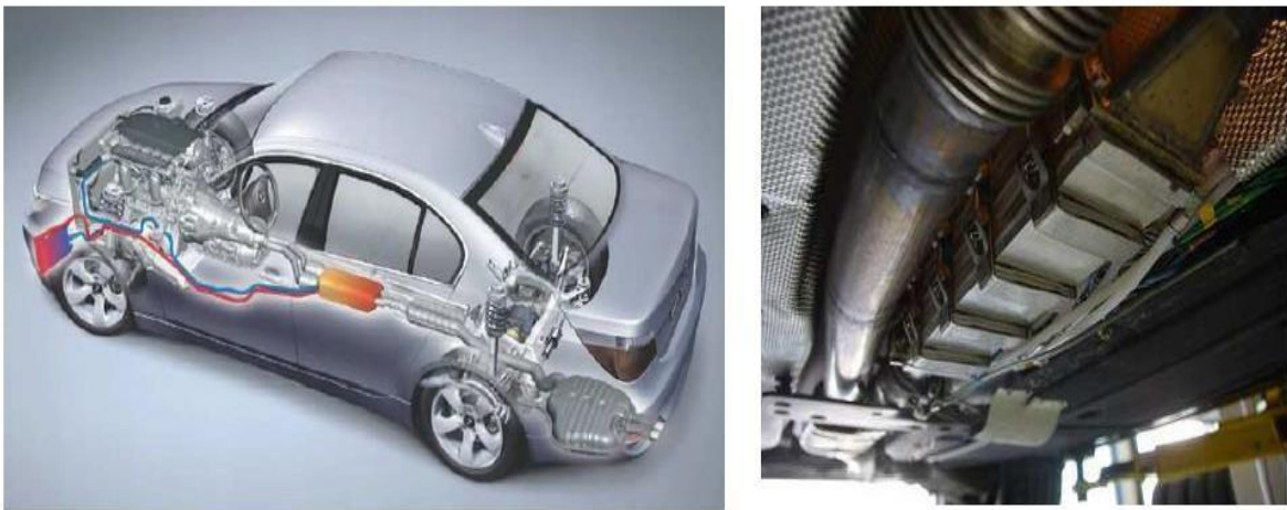
Figure I.17 : Conception d'un générateur thermoélectrique produisant de l'électricité de la chaleur perdue au niveau du pot d'échappement d'un véhicule (source BMW)[70].
