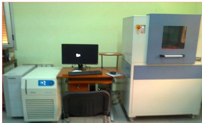
**Figure II.24 :** Diffractomètre a rayons X (EQUIN 3000 X) utilisée au laboratoire.
