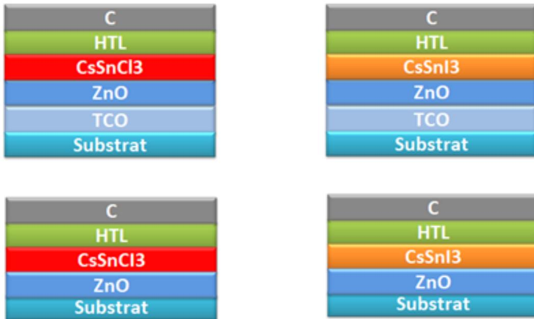
**Figure V.1** : Représentation schématique de l'architecture du dispositif étudié
