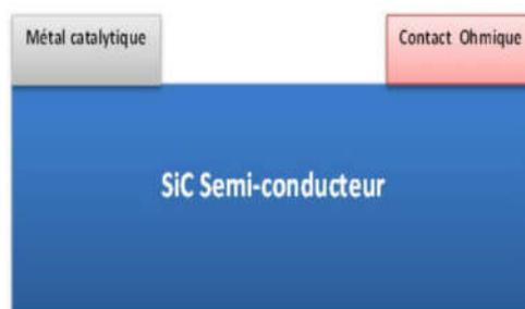
**Figure II-8:** Schéma représentatif des capteurs de gaz basés sur la diode Schottky [18].
