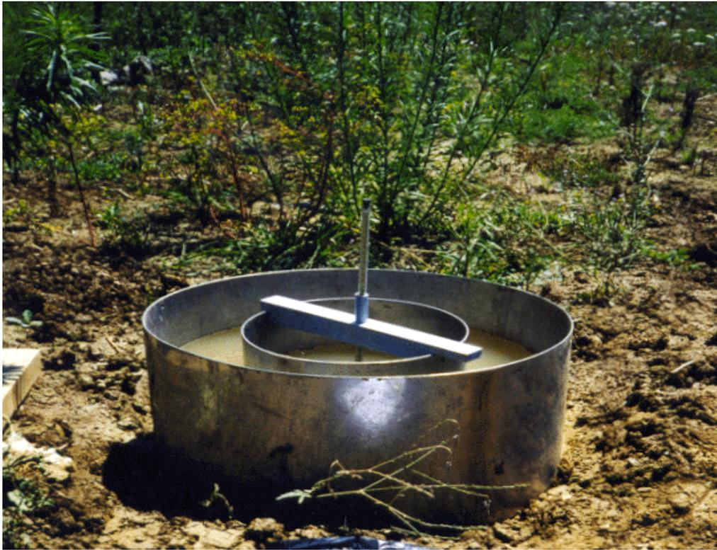
**Figure III.12 : Infiltromètre à double anneau**
