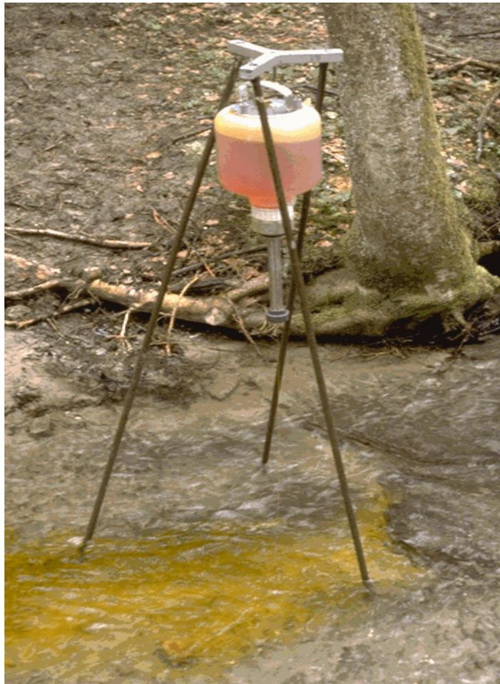
Figure V .14 : Principe du jaugeage par injection à débit constant (André Musy ,2004).
