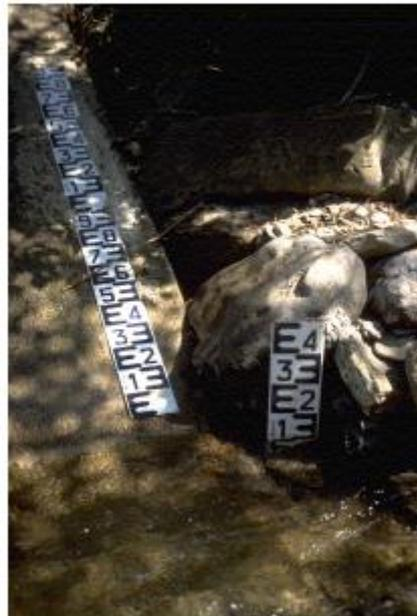
Figure V.2 : Echelles limnimétriques inclinée et verticale
