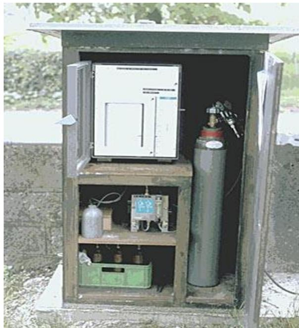
**Figure V.5 : Schéma du limnigraph à pression photo: EPFL Lausanne**
