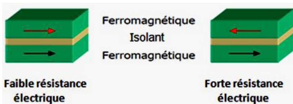
Figure I.13: les deux états, parallèle et antiparallèle, dans une jonction tunnel magnétique [44].
