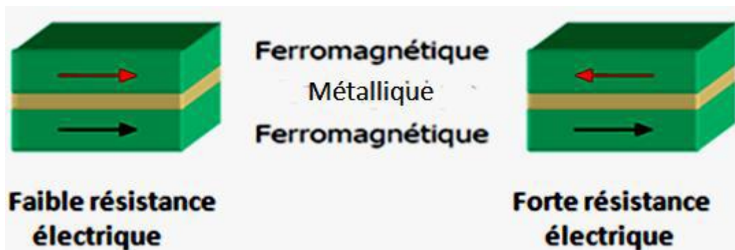
Figure I.12: les deux états, parallèle et antiparallèle, dans une jonction géante magnétique.
