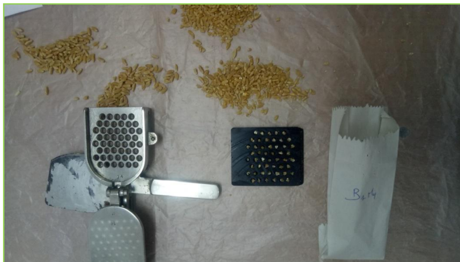
Figure 20. Détermination du taux de mitadinage à l'aide d'un farinotome de Pohl.
