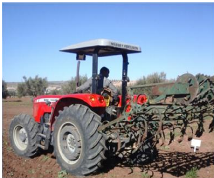
Figure 18. Destruction des adventices avant le semis par une herse combinée à un rouleau cage, au niveau des parcelles élémentaires des modalités M2 et M3.
