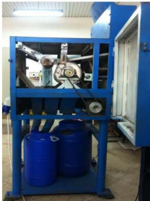
Figure V.1 : Séparateur électrostatique semi-industrielle réalisé au laboratoire IRECOM-UDL-SBA
